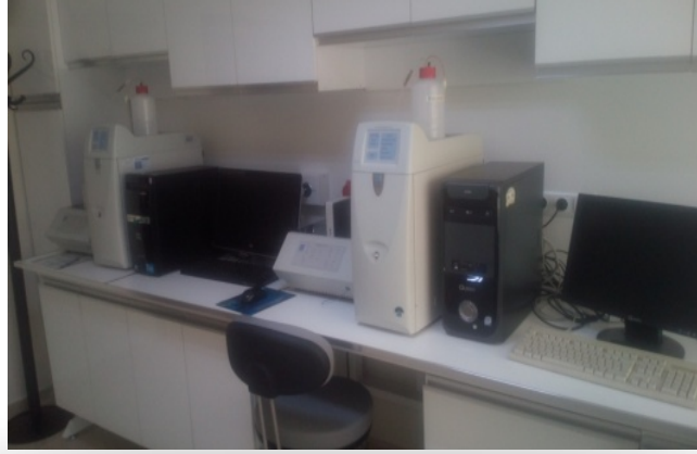
Resim 2.15. Taşınabilir kolorimetre ve ICS-1000 iyon kromatografi cihazı
