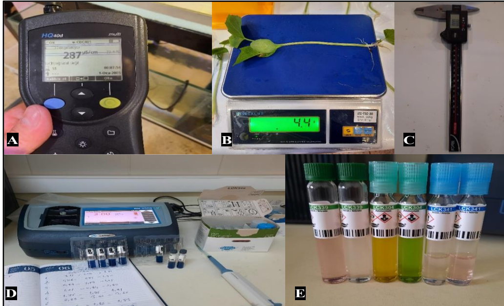
Şekil 8. Deneyde kullanılan ölçüm aletleri. A: Orion Star™ A329 marka multiparametre cihazı; B: 0,1 g hassasiyetli Necklife Jzs-Tsc model dijital terazi; C: Bitki gelişim ölçümü için kumpas aleti D: Hach DR3900 spektrofotometre cihazı; E: Su parametreleri analiz kitleri.
