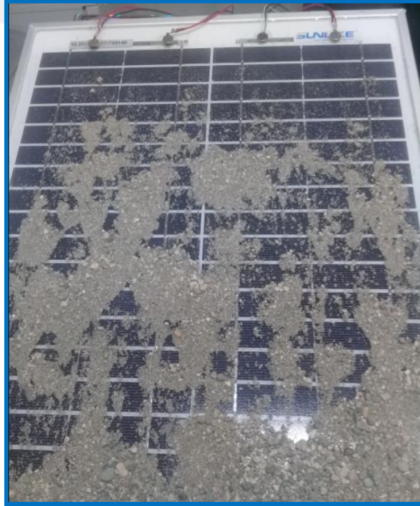
Şekil 4.11. Akustik yüzey dalga uygulamasından sonra kum tanelerinden kısmi olarak temizlenen panelin resmi
