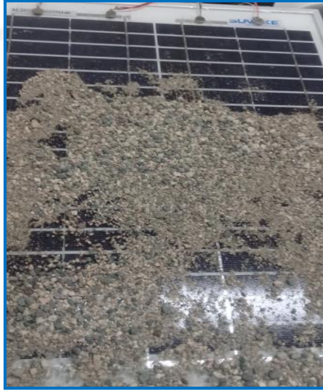
Şekil 4.14. Akustik temizlik sonrasında kısmi olarak temizlenmiş panel yüzeyi ve kum yığının oluşumu
