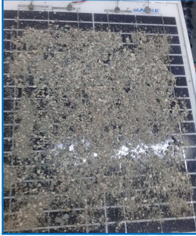
Şekil 4.13. Temizlik öncesi ince kum ile kirlenmiş panel
