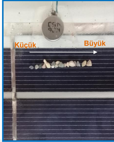
Şekil 5.1. Sıfır derece panel açısında farklı boyutlarda kum tanelerinin panel yüzeyine dizilimi. Soldan sağa doğru ortalama parçacık büyüklüğü artmaktadır.
