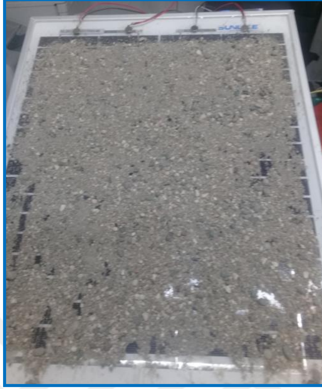
Şekil 4.10. Temizlik öncesi kum ile kirlenmiş panel
