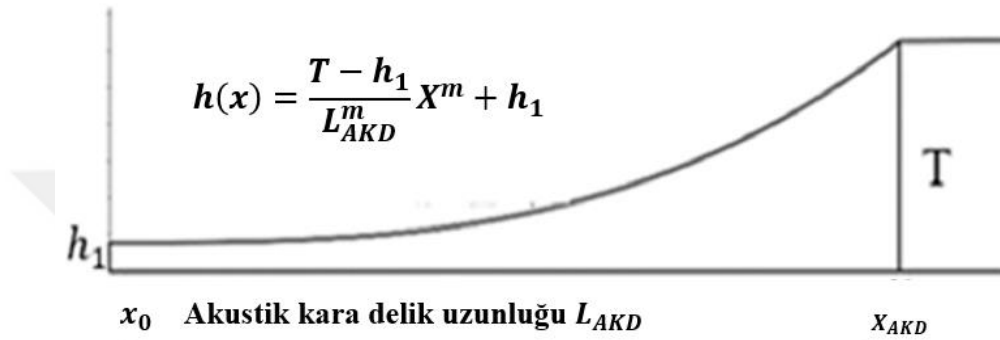
Şekil 1.20: Bir boyutta akustik kara deliğin şematik gösterimi [54].
