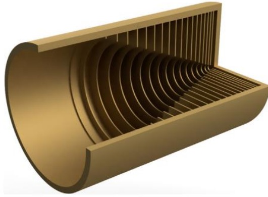
Şekil 1.21: Akustik dalga kılavuzunun içine gömülü 3 boyutlu akustik kara delik gösterimi [60].
