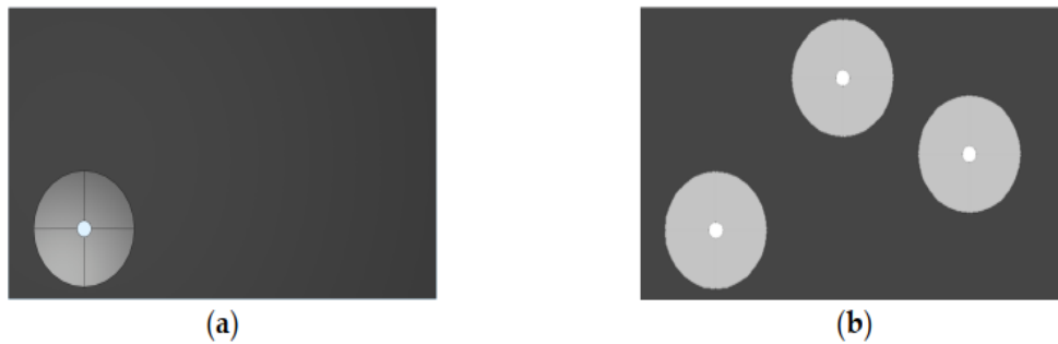
Şekil 1.12: (a) Merkez delikli tekil iki boyutlu akustik kara delik, (b) Merkez delikli üç tane iki boyutlu akustik kara delik [11,47].
