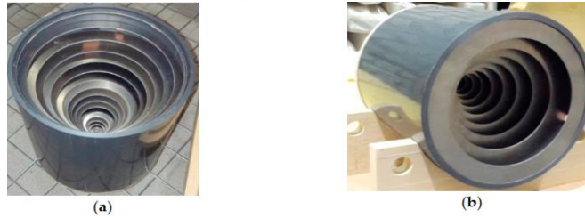
Şekil 1.19: (a) Üstel m=1 olan akustik kara deliğin ve (b) üstel m=2 olan akustik kara deliğin fotoğrafı [11,52].
