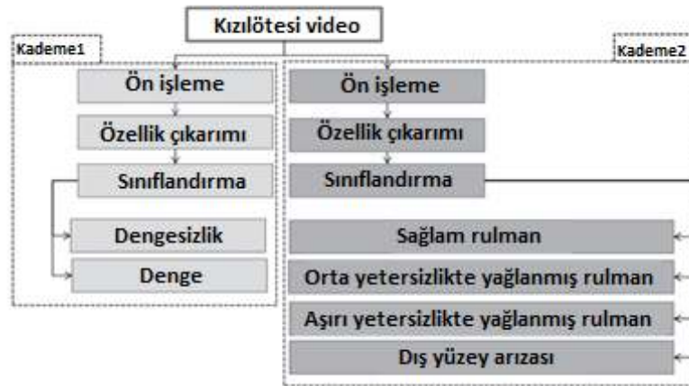
Şekil 2.6. İki kademeli ısı görüntü işleme blok diyagramı [6]
