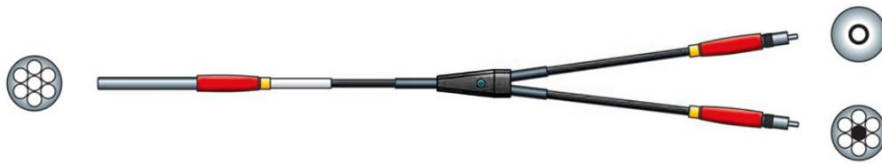
Şekil 3. 3. Çalışmada kullanılan fiber optik probun şematik görüntüsü
