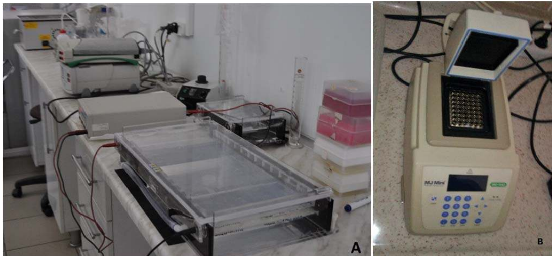
Şekil 3.12. A. PCR Elektroforez Tankı, B. Termal Cycle (Orijinal)
