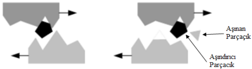
Şekil 15. Üç cisimli abrazyon aşınması
