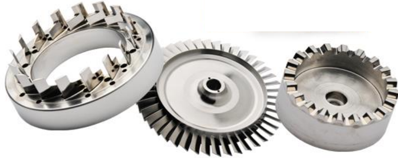
Şekil 2. 6 EKİ yöntemi ile yapılmış disk örnekleri[24]
