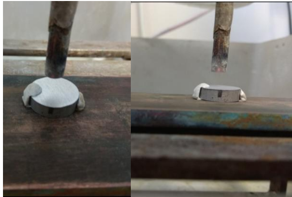
Şekil 3. 5 İş parçasının elektrokimyasal işleme tezgahına yerleştirilmesi
