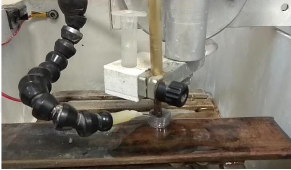
Şekil 3. 6 Elektrokimyasal İşleme anından bir görüntü
