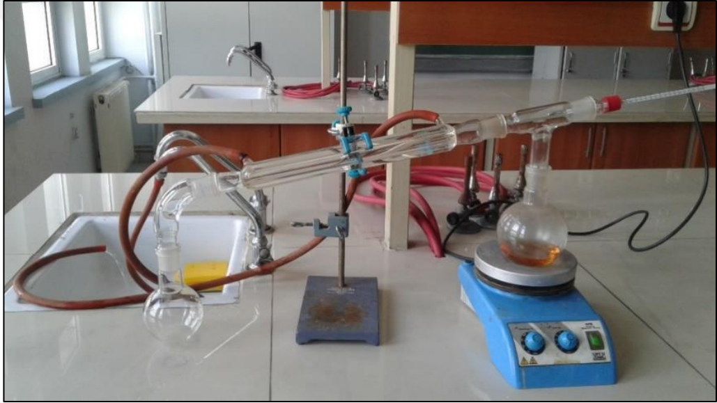
Şekil 4.1. Anilin monomer damıtma düzeneği.
