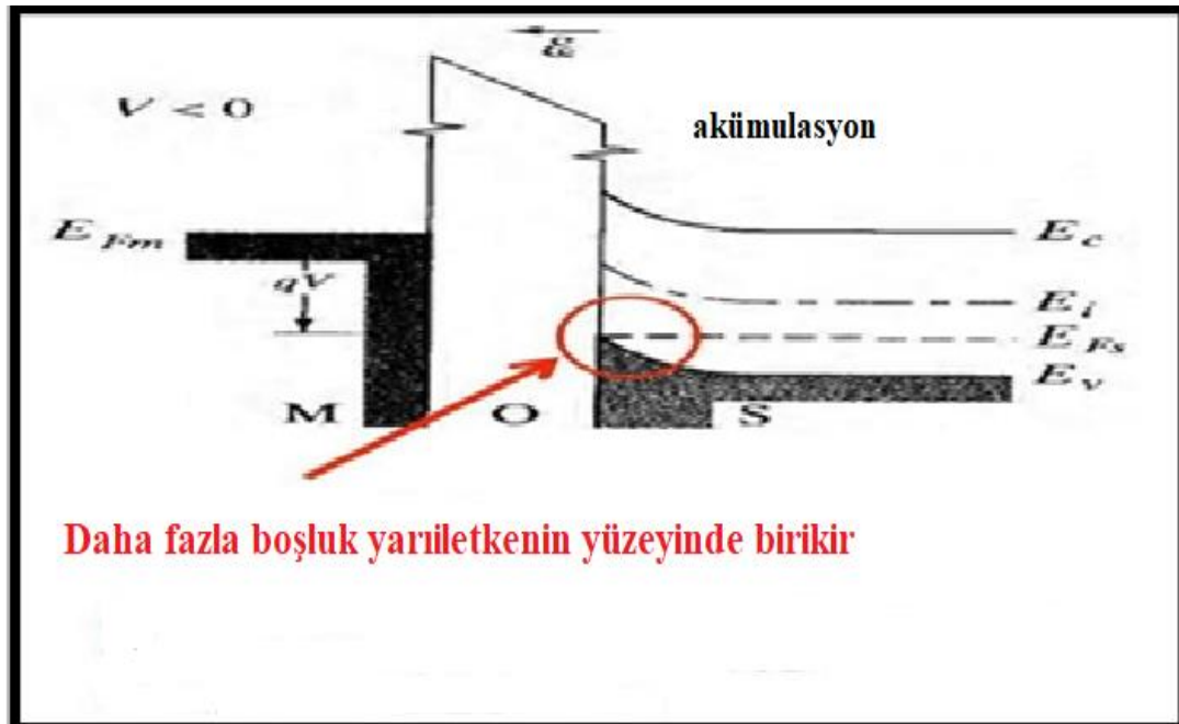
Şekil 2.9 Birikim bölgesinde enerji band diyagramı
