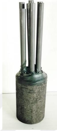
Şekil 3.1. Grafitten yapılmış numune kalıplar.
