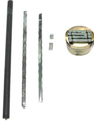
Şekil 3.7. Numune kalıplarından epoksi- resin ile kalıplanma aşamasına kadar yapılan işlemlerin gösterimi.
