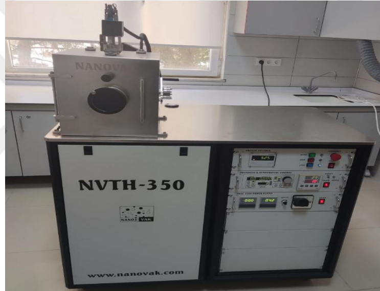
Şekil 3.4. Nanovak NVTH-350 Termal buharlaştırma cihazı (Batman Üniversitesi).
