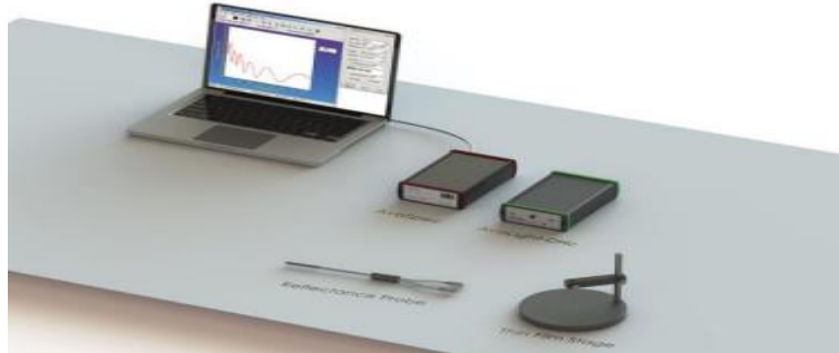
Şekil 3.7. İnce film kalınlık ölçer spektrofotometre (Avantes AvaSpec-ULS2048).
