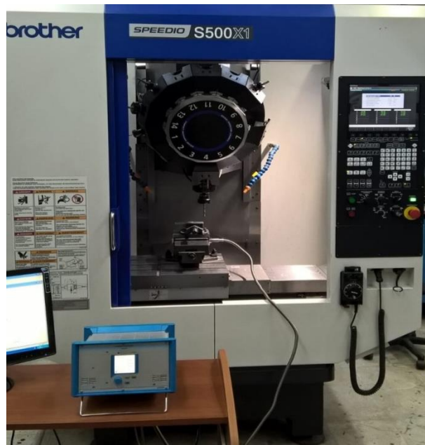
Şekil 3.8. Deneylerde kullanılan CNC dik işleme merkezi
