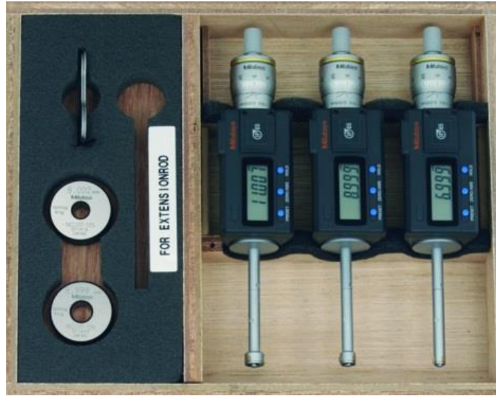
Şekil 3.14. Delik çapı ölçümünde kullanılan iç çap mikrometresi
