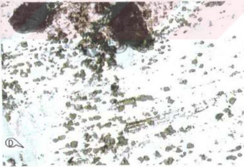
Resim 5.24. 600 °C' de 2 MPa Basınçta ve 90 Dakika Kaynak Şartlarında Kaynak Edilen Numunenin Dağlanmış Halde Fotoğrafı (X400)
