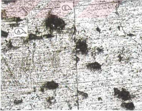
Resim 5.16. 600 °C' de 2 MPa Basınçta ve 90 Dakika Kaynak Şartlarında Kaynak Edilen Numunenin Dağlanmış Halde Fotoğrafı (X100)
