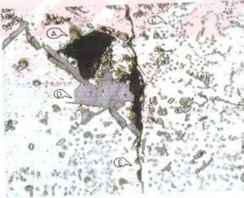
Resim 5.10. 550 °C' de 2 MPa Basınçta ve 90 Dakika Kaynak Şartlarında Kaynak Edilen Numunenin Dağlanmış Halde Optik Fotoğrafi (X400)
