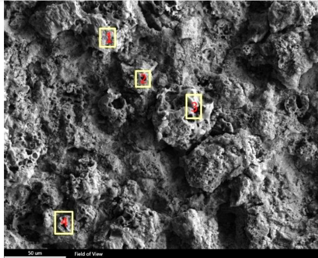
Şekil 4. 22. Silikatlı elektrolit içerisinde kaplanan Al-2Mg-12Zn üzerinde oluşturulan MAO kaplamanın yüzey SEM görüntüsü.
