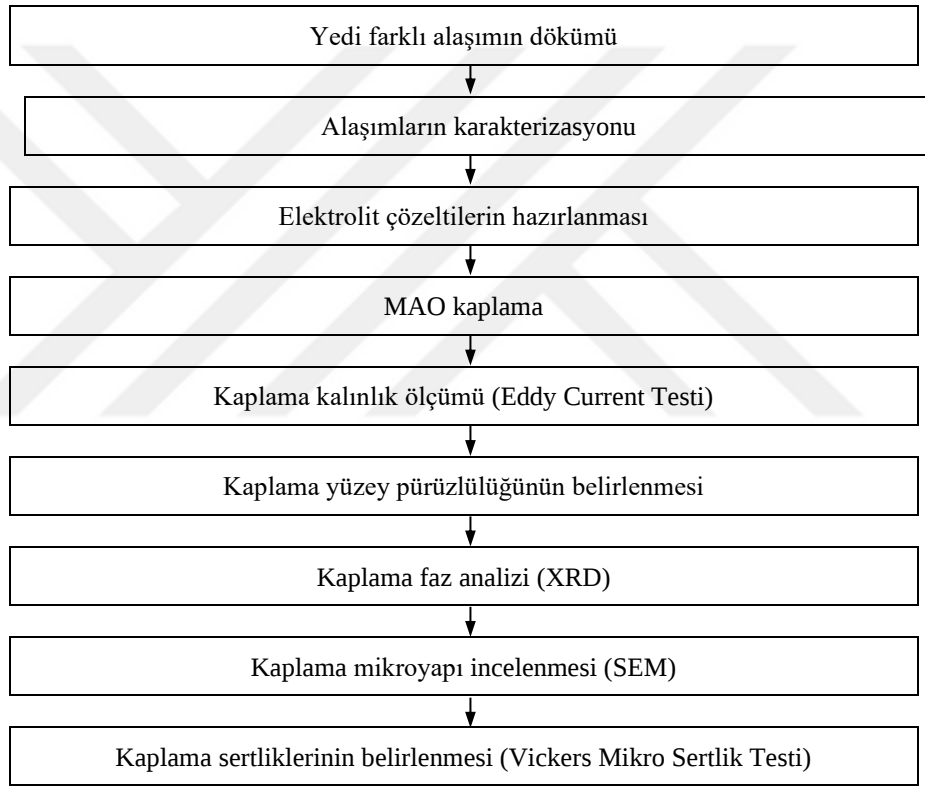
Şekil 3. 1. Deneysel çalışma adımlarını gösteren akış şeması.
