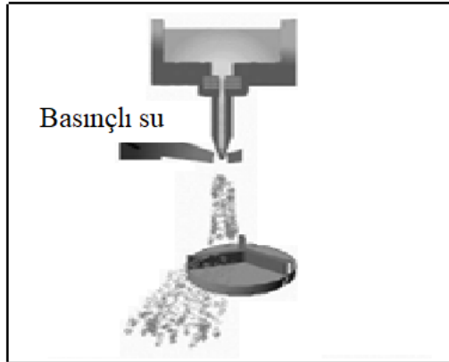
Şekil 1.19. Döner disk atomizasyon tekniği (Baksan ve Gürler, 2003)
