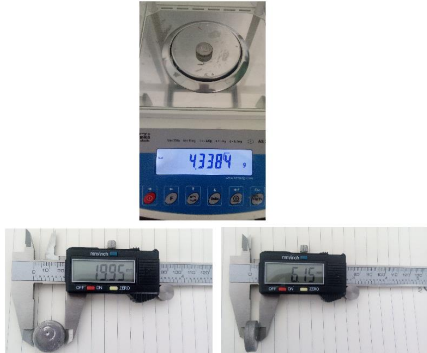
Şekil 3.13. Al-Ni/GO numunesine ait kütle, çap ve yükseklik ölçümleri
