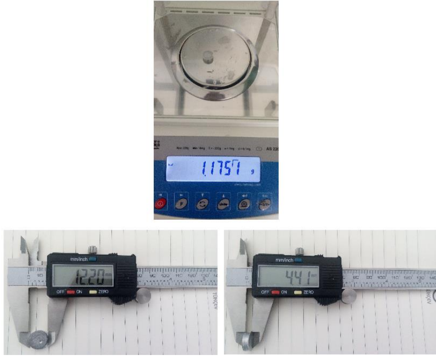
Şekil 3.12. Al-Ni/TiO 2 numunesine ait kütle, çap ve yükseklik ölçümleri
