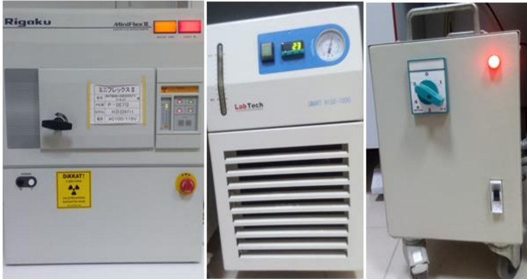
Şekil 3.10. XRD cihazı ve kısımları
