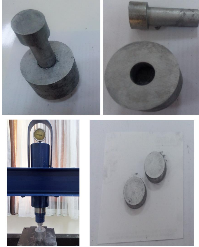
Şekil 3.4. Kalıp, Cihaz ve Presleme sonrası numune görüntüsü
