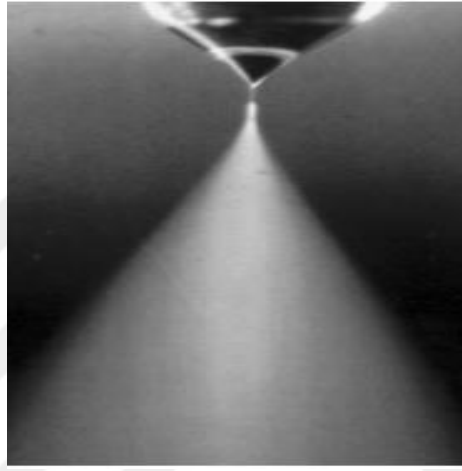
Şekil 2.40. HCl asitin küçük bir miktarını içeren metanol'ün koni-püskürtme biçimli spray görüntüsü (Perednis and Gauckler 2005)
