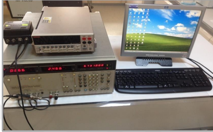
Şekil 3.15. Üretilen diyotların oda sıcaklığında I - V , C - V , G - \omega - V ve C - f ölçümlerinin alındığı sistemler
