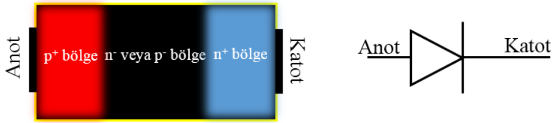
Şekil 2.33. PIN diyot ve çevrim sembolüne ait şematik gösterim
