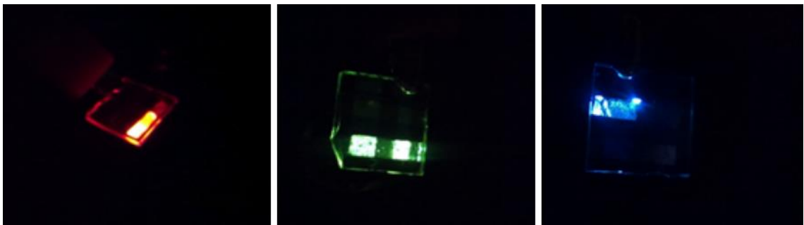
Şekil 4.84. AZO anot elektrotlu PLED’lere ait emisyon fotoğrafları
