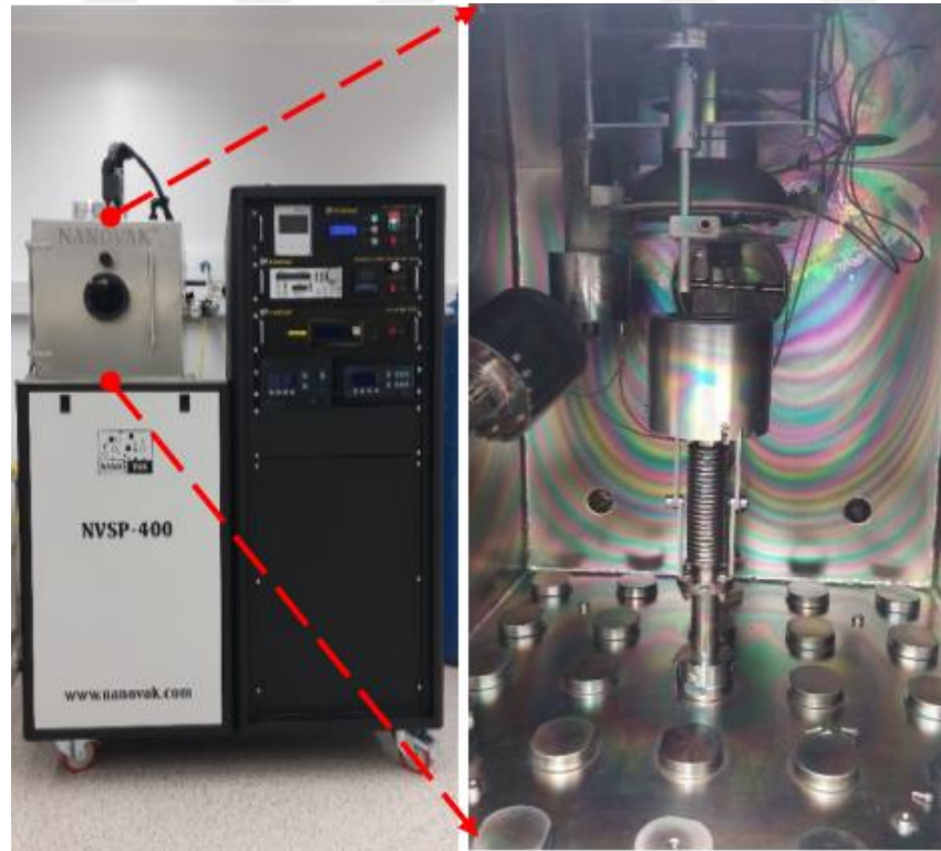
Şekil 3.4. RF saçtırma yöntemi ile ince film büyütme sistemine ait fotoğraf
