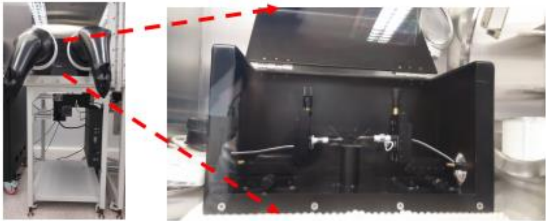
Şekil 3.13. Glovebox bütünleşik güneş simülatörü ve prob istasyonu
