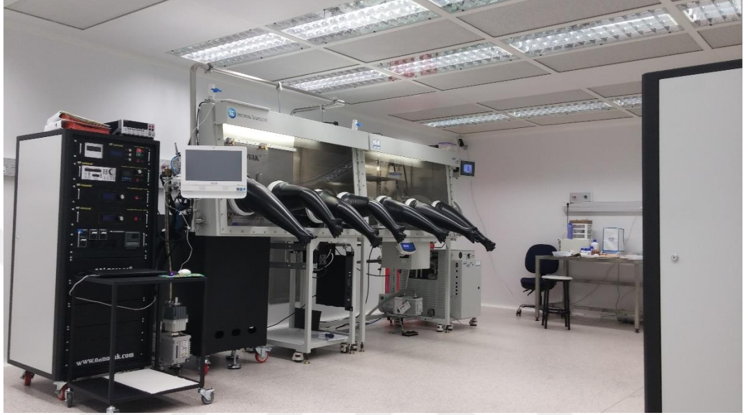
Şekil 3.1. Atatürk Üniversitesi Fen Fakültesi Fizik Bölümü Nanoaygıt Üretimi ve Karakterizasyon Laboratuvarı bünyesinde kurulmuş sınıf 1000 (ISO 6) temiz oda
