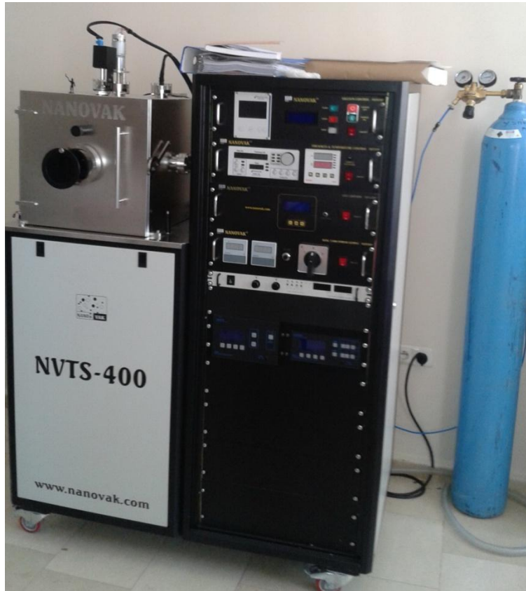
Şekil 3.8. ZnO ve Al katkılama işlemlerinin gerçekleştirildiği vakum sistemi
