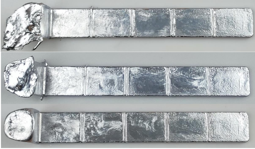
Şekil 23: K-Mold Kalıbına Yapılan Döküm Numune Görüntüleri
