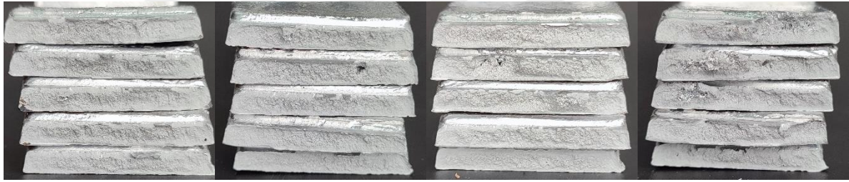
Şekil 24: K-Mold Numuneleri Kırık Yüzey Numune Görüntüleri
