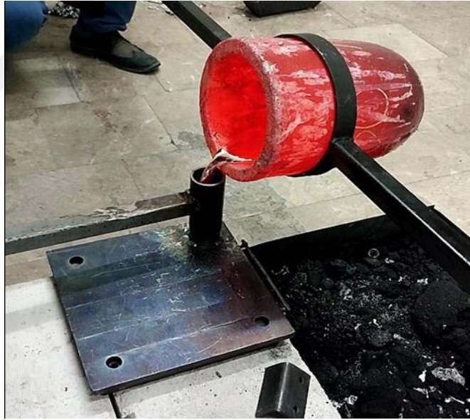
Şekil 10: Sıvı Metalin Kokil Kalıplara Dökümü
