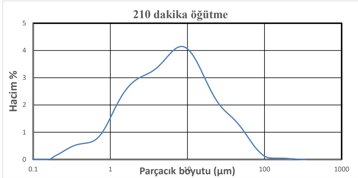
Şekil 4.29. Al 2 O 3 -TiB 2 toz karışımının tungsten karbür öğütme ortamında 210 dakika öğütülmesi ile oluşan ürünlerin parçacık boyut dağılımı
