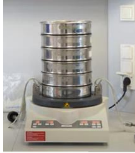
Şekil 4.5. Sieve Shaker ANALYSETTE 3 PRO sarsma cihazı ve elekler
