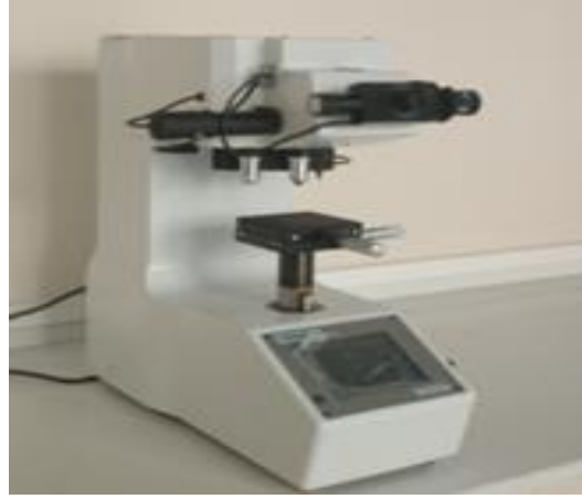
Şekil 4.18. TTS Matsuzawa marka HWMMT-X3 model sertlik ölçüm cihazı
