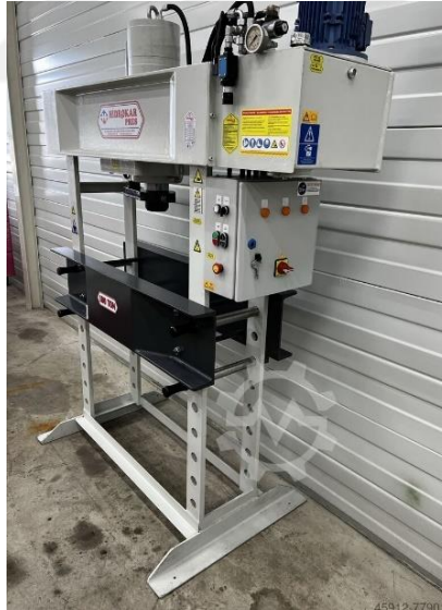
Şekil 4.7. 50 ton kapasiteli hidrolik pres
