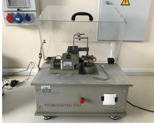
Şekil 4.20. UTS Tribometer T20 marka aşınma deney cihazı
