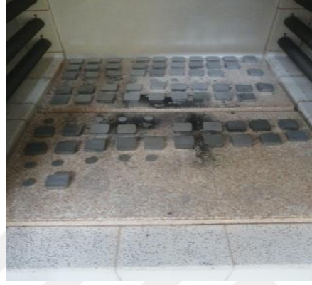
Şekil 4.14. Tav fırınında sinterleme
