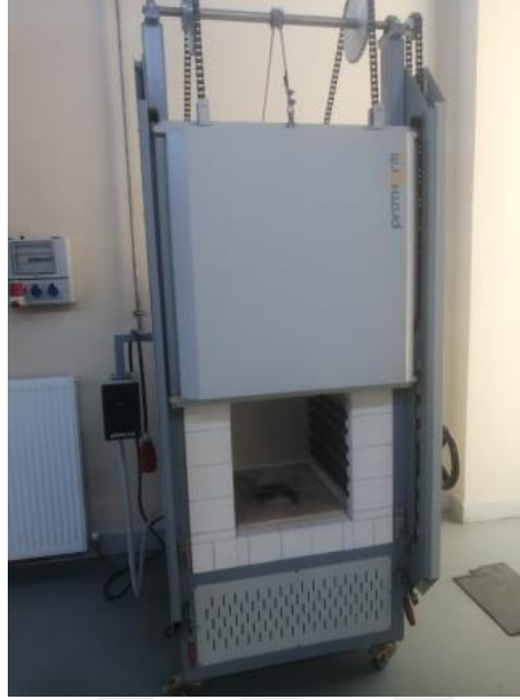
Şekil 4.11. Protherm marka PLF 110/45 model tav fırını
