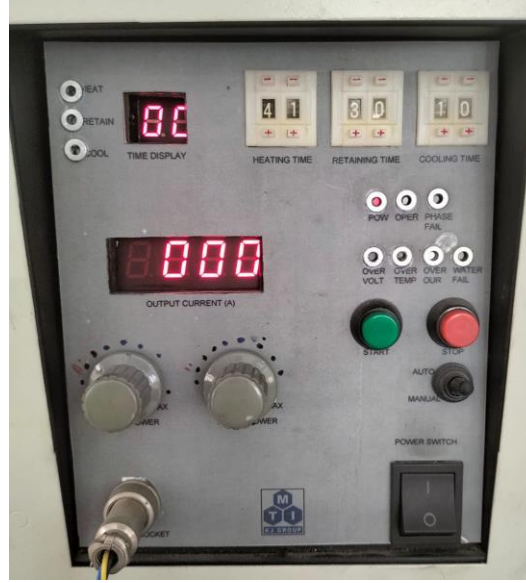
Şekil 5.11. İndüksiyonla ısıtma işlemi parametrelerinin ayarlandığı kontrol paneli
