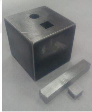
Şekil 5.6. Presleme işleminde kullanılan paslanmaz çelik kalıp
