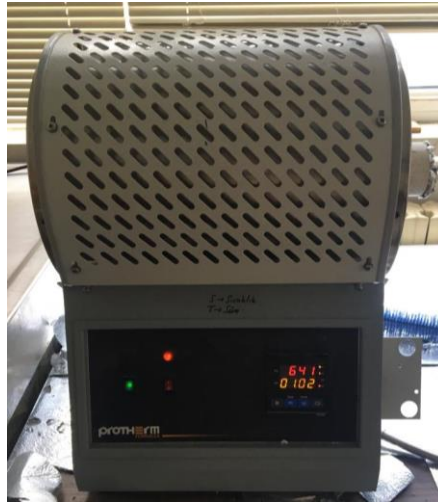
Şekil 5.8. Sinterleme işleminde kullanılan tüp fırın
