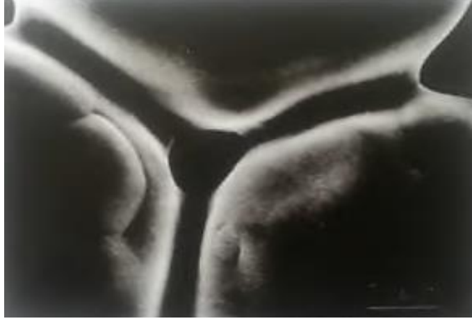
Şekil 4.7. Sinterleme işlemi esnasındaki boyun oluşumu (Kalaycıoğlu, 2010)
