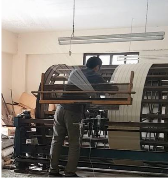
Şekil 4.114. Çözüde ipliklerin karışmasını önleyen ağızlık kısmının oluşması (Azime Güven Arşivi, Alanya 2019).
