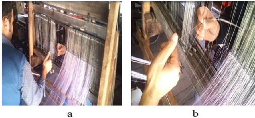
Şekil 4.121. a. b. İpek iplik çözgüleri gücü tellerinden geçirilmesi (Azime Güven Arşivi, Alanya 2019).
