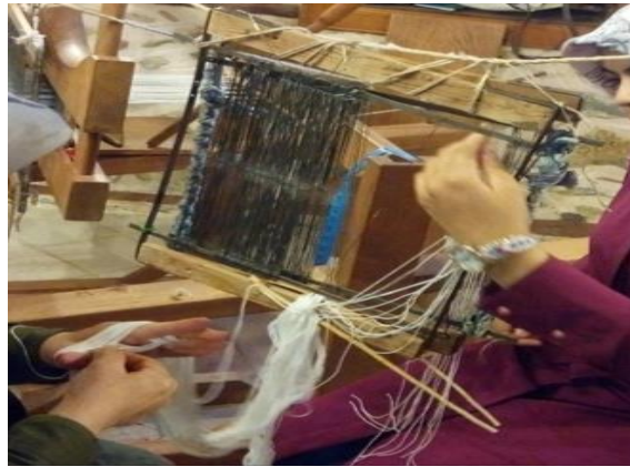
Şekil 4.35. İpek iplik çözgüleri gücü tellerinden geçirilmesi (Azime Güven Arşivi, Alanya, 2019).
