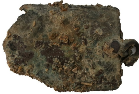
Fig. 36: Kemer Tokasının Yüzeyinde Oluşan Yoğun Kekmoz Tabakası
