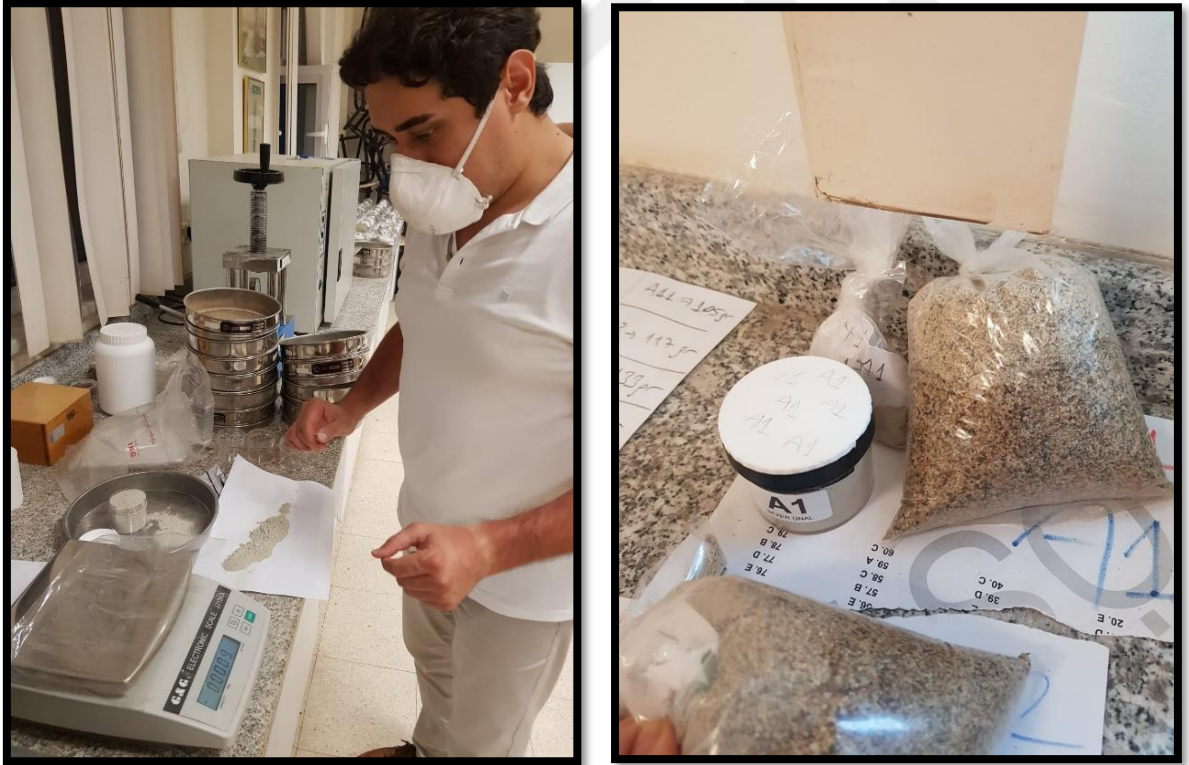
Şekil 4.7. Sahil Kumu Örneklerin Terazi’de Tartılması ve İzole Bant ile Kapatılması
