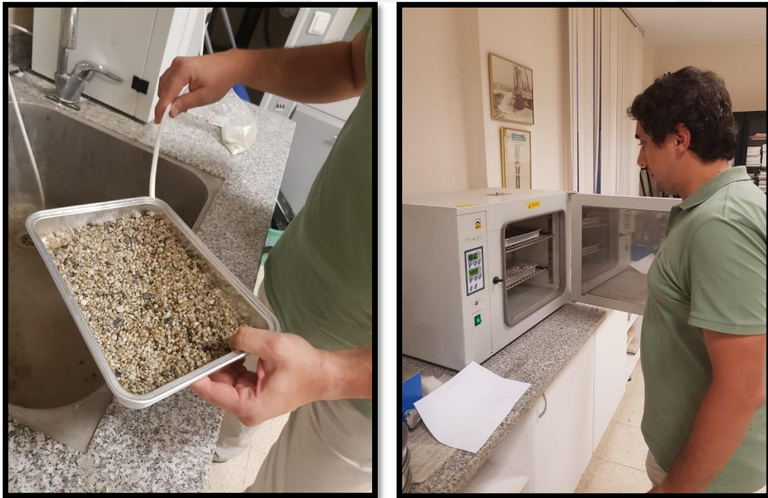
Şekil 4.5. Sahil Kumlarının Temizlenmesi ve Etüv’de Kurutulması
