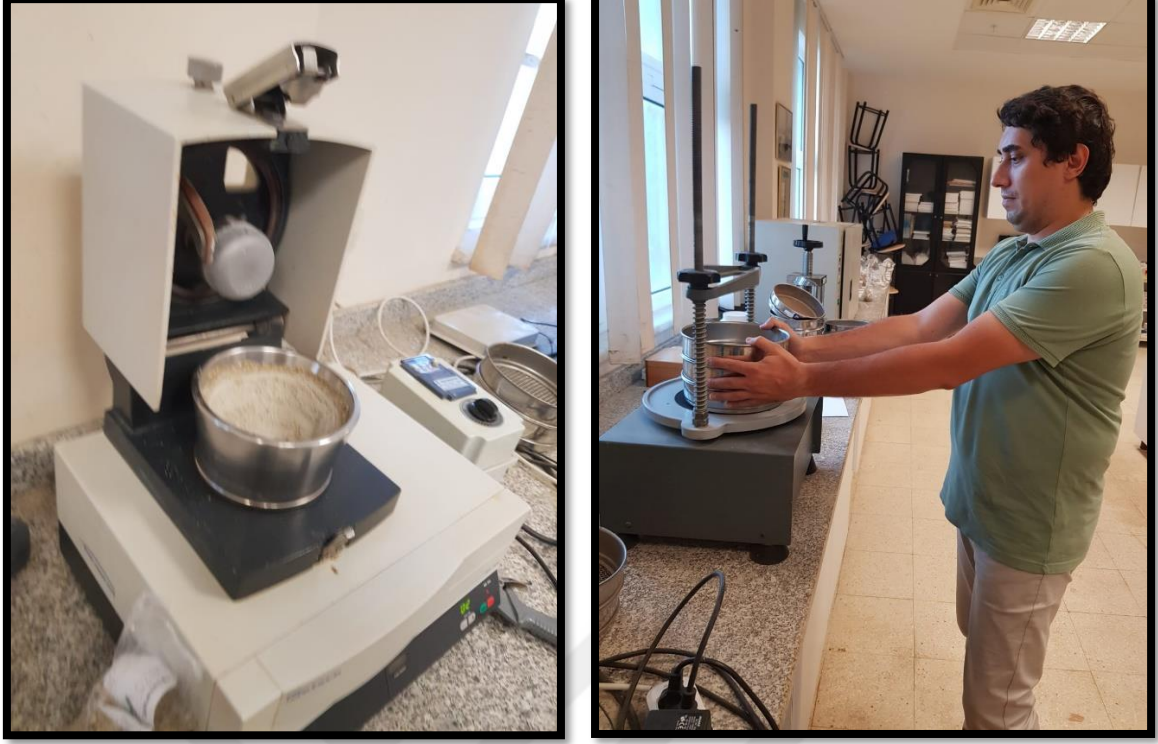
Şekil 4.6. Sahil Kumlarının Öğütülmesi ve Elekten Geçirilmesi
