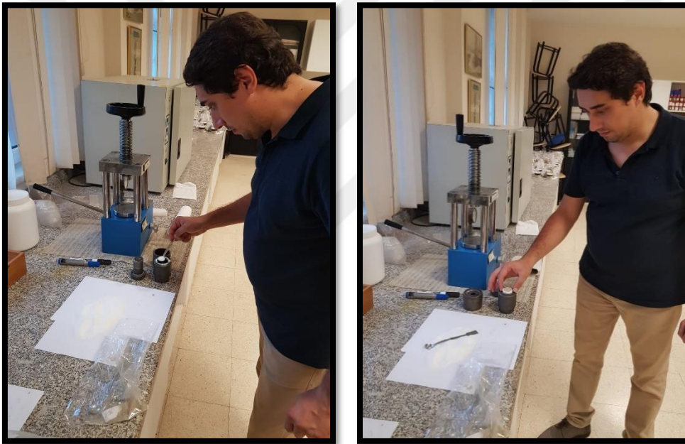
Şekil 4.15. Sahil Kumu Numunelerinin Pellet Haline Getirilmesi
