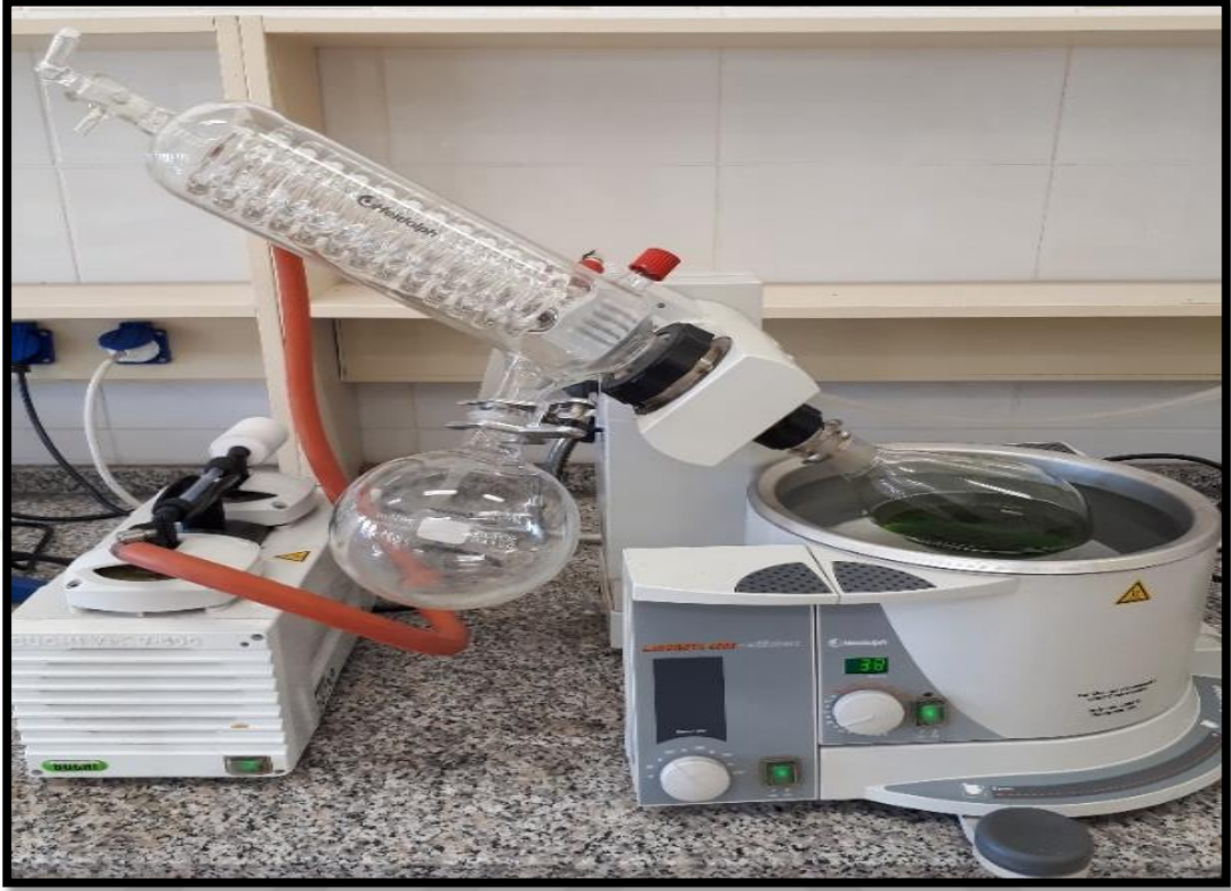
Şekil 2. Ekstrelerin Rotavaporda Yoğunlaştırılması
