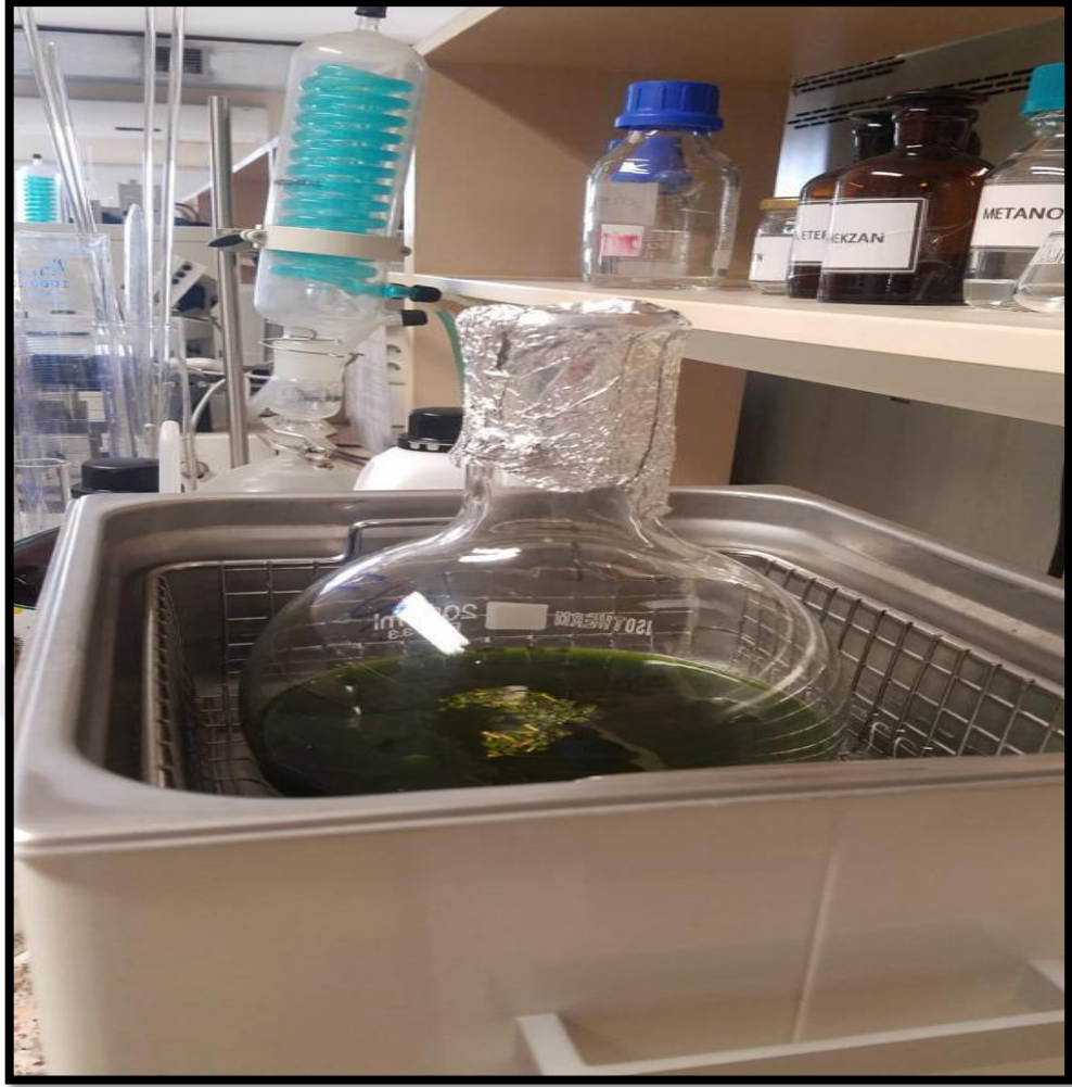
Şekil 4. Ultrasonik Banyoda Ses Destekli Ekstraksiyon
