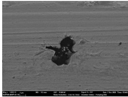
Şekil 5.22. Oda Sıcaklığında Gerçekleştirilen Aşınma Deneyinde Mn ile Alaşımlandırılan KGDD'nin Aşınma Yüzeyinde Deformasyona Uğrayan Küresel Grafit.
