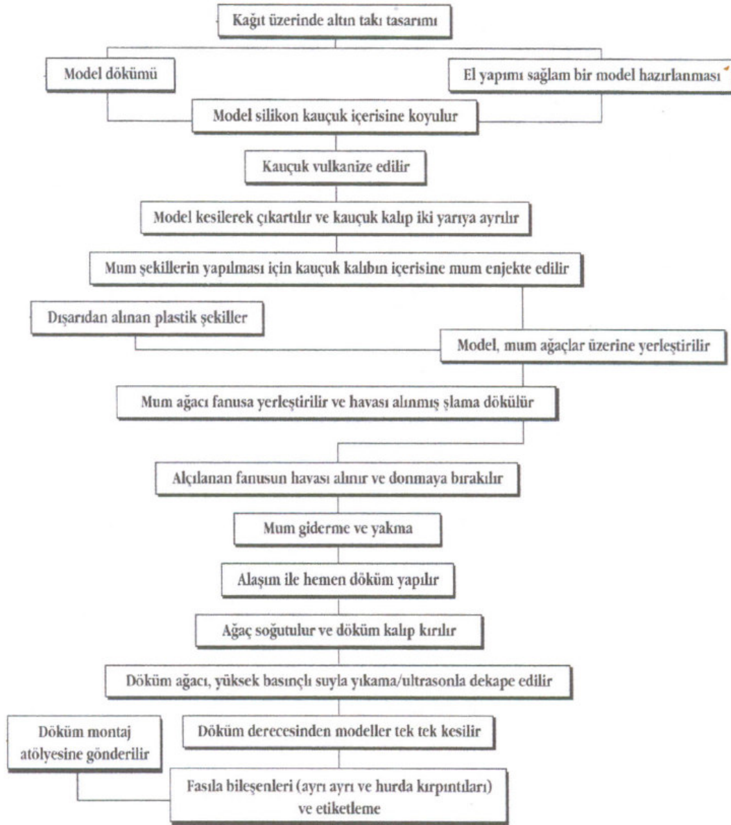
Şekil 4.2 Kuyumculukta dereceli hassas döküm işlem kademeleri (Wright, 1998).
