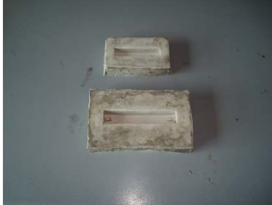
Şekil 8.4 Numunelerin döküldüğü silikon kalıplar
