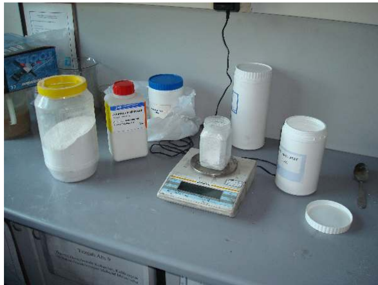
Şekil 8.1 Toz karışımının hassas terazide tartılarak hazırlanması
