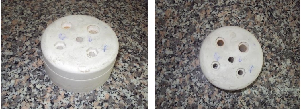
Şekil 7. 7 SEM’de incelenecek numunelerinin döküldüğü kalıp
