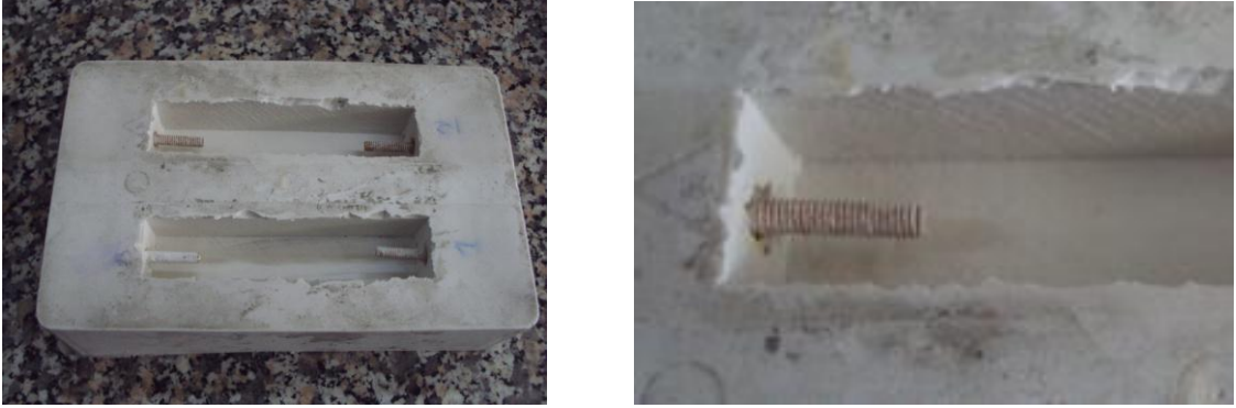
Şekil 7. 5 Prizlenme genleşmesi numunelerinin döküldüğü kalıp
