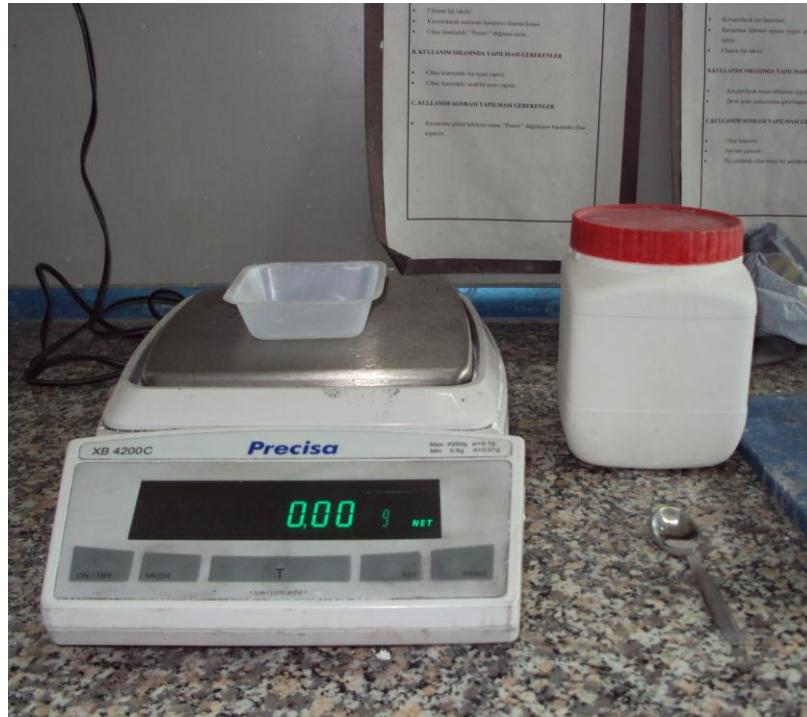
Şekil 7. 2 Toz malzemelerin tartıldığı hassas terazi ve karıştırma kabı
