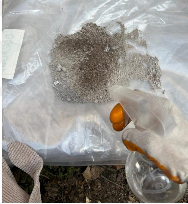
Şekil 3.8. Kuru karışıma su ilavesi yapılması
