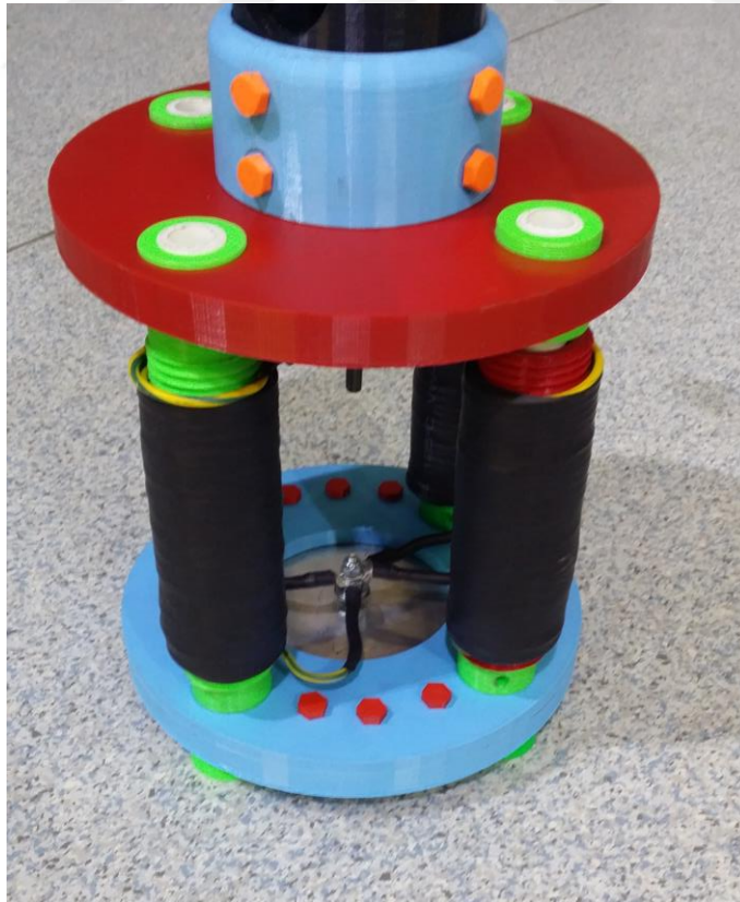
Şekil 5.41. Bobinler ve 3 boyutlu yazıcı ile üretilen disklerin birleştirilmiş hali
