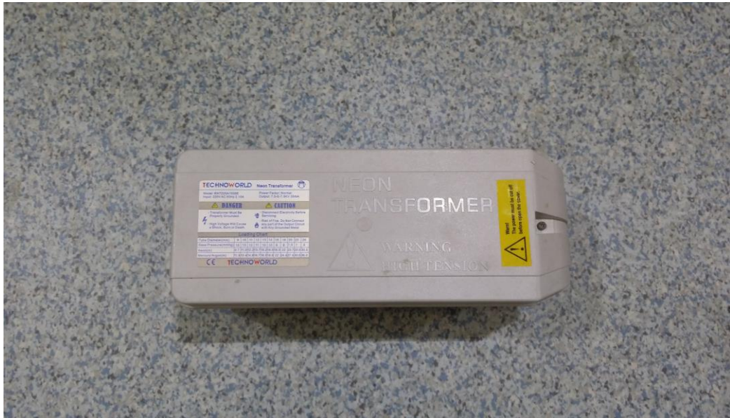
Şekil 5.12. Tez çalışması kapsamında üretilen darbe setinin enerji beslemesi için kullanılan neon transformatörü
