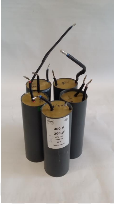
Şekil 5.4. Darbe kondansatörlerini oluşturmak için kullanılan kondansatör blokları
