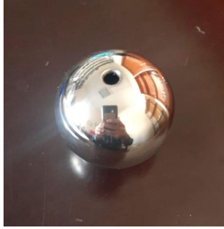
Şekil 5.24. Küre küre elektrot anahtarlama sisteminde kullanılan 42 mm çapında paslanmaz çelik küre
