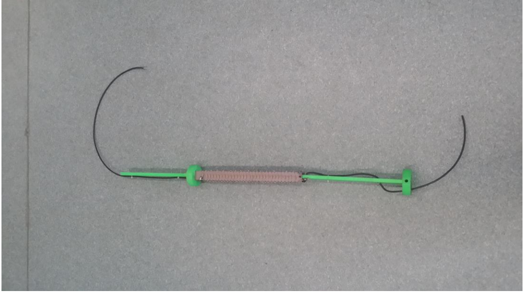
Şekil 5.17. Üretilen omik gerilim bölücünün iç yapısı
