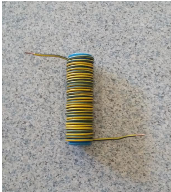
Şekil 5.35. Karkas etrafına sarılan 2.7 mm çapındaki bakır nya kablo
