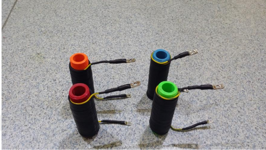
Şekil 5.37. Üretilen bobinlerin giriş ve çıkış uçlarına takılan kablo pabucu ve bobinlerin etrafına yerleştirilen ısıyla daralan makaron
