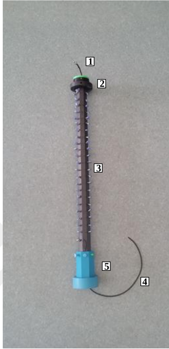
Şekil 5.22. Üretilen kapasitif gerilim bölücünün iç yapısı; 1) Kapasitif gerilim bölücünün giriş bağlantı kablosu, 2) 3 boyutlu yazıcı ile üretilen kapak, 3) Seri bağlı mkp kondansatörler, 4) Kapasitif gerilim bölücünün çıkış bağlantı kablosu, 5) 3 boyutlu yazıcı ile üretilen gerilim bölücü ayağı
