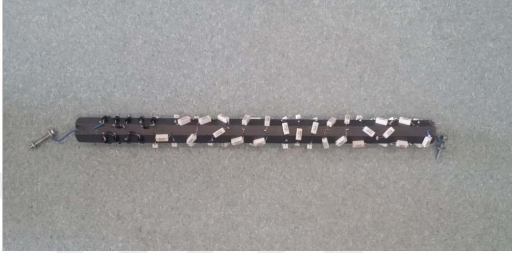
Şekil 5.14. Üretilen doğrultma katının iç yapısı
