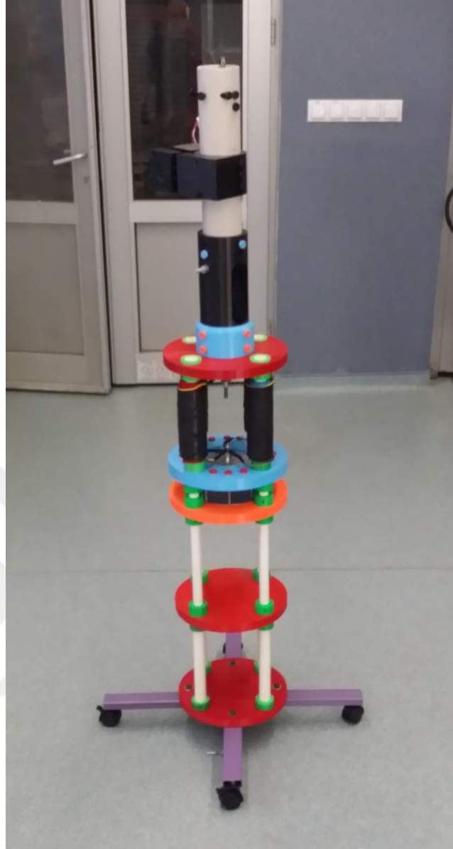
Şekil 5.44. Bobin ve küre küre elektrot sisteminden oluşan yapı
