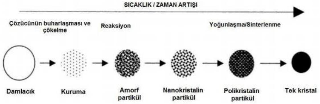
Şekil 3.13. Sprey pirolizi ile üretim süreci [73]
