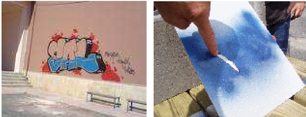
Şekil 3.8. Alev sprej yöntemiyle üretilen polimer kaplamanın boyanmazlık özelliği [22]
