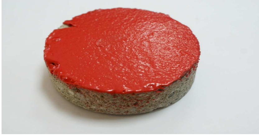
Şekil 6.16. Beton üzerine polimer kaplama
