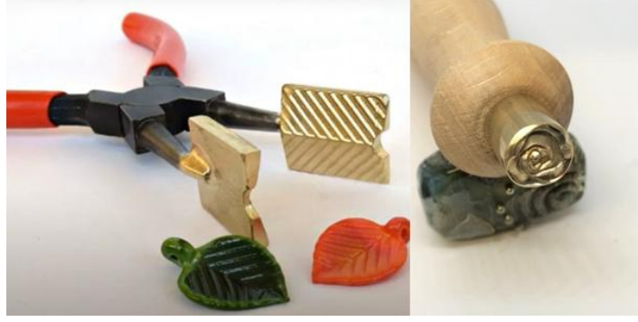
Görsel 5.40. Sıcak cam yüzeyine doku oluşturma yöntemi
