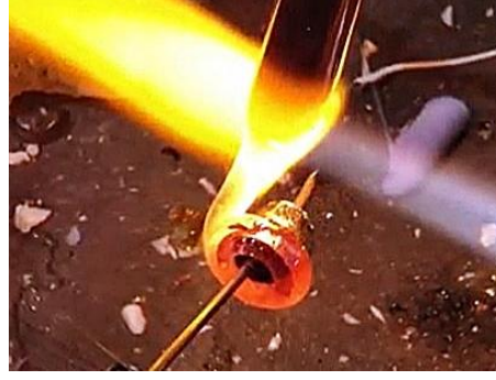
Görsel 5.3. Mandrele cam sarma işlemi
