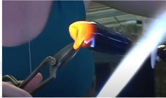
Görsel 5.29. Kesme yöntemi uygulama aşaması
