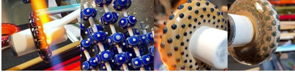
Görsel 5.43. Noktalama yöntemi, cam boncuk tasarım çalışmaları
