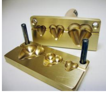
Görsel 5.30. Alevde cam şekillendirme için kullanılan kalıp örnekleri ( https://www.instagram.com/p/Ben6cilnVe0/ )
