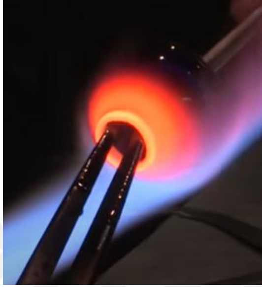
Görsel 5.39. Farklı materyaller kullanılarak ağız açma işlemi
