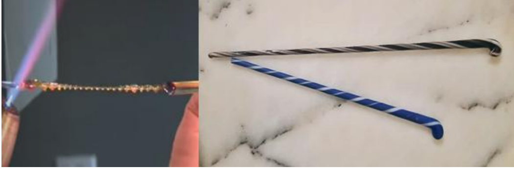
Görsel 5.24. Bölgesel farklı kalınlıklara sahip cam çubuklar
