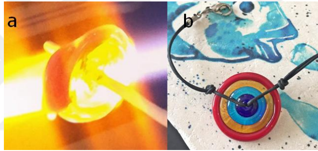
Görsel 5.9. Disk boncuk, et kalınlığı farklı ürün (a), disk boncuk eşit et kalınlık verilmiş ürün (b) (B. Tosun Akın, 2021)
