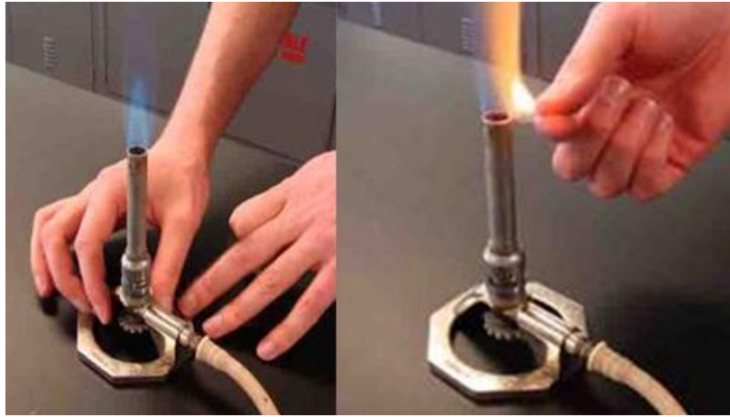
Görsel 3.8. Bunsen Burner şaloma, çalışma aşaması
