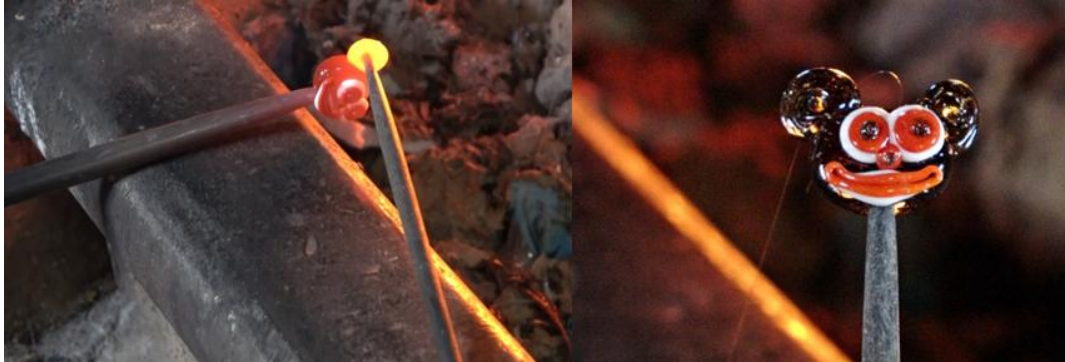
Görsel 6.12. Geleneksel cam boncuk fırınında ergimiş camın şekillendirme aşaması (B. Tosun Akın, 2021)
