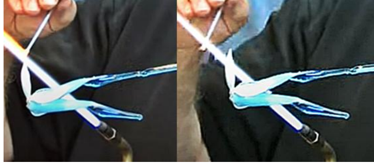
Görsel 5.15. Ayırma tekniği biblo uygulama aşaması ( https://www.youtube.com/watch?v=FYEQncNl4W0 )
