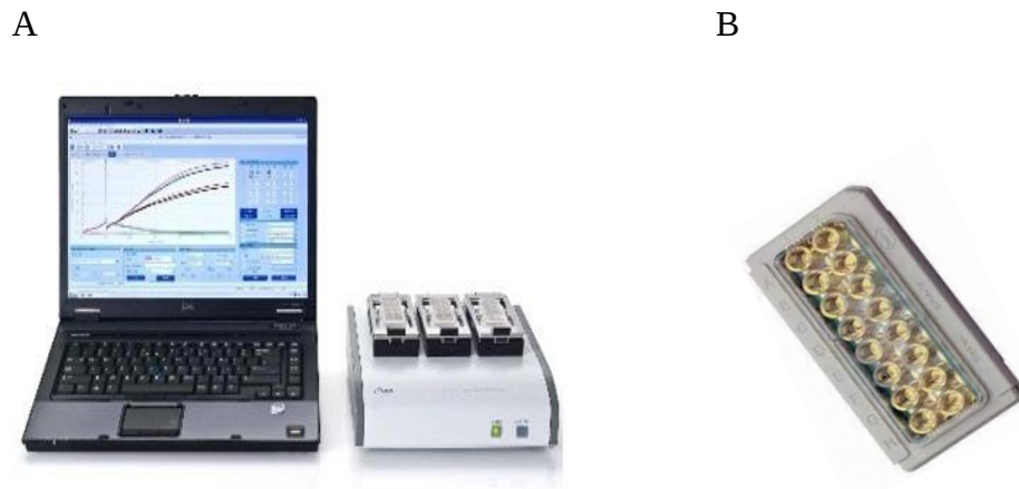
Görsel 4.3. Gerçek zamanlı hücre analizi çalışmalarında kullanılan xCELLigence RTCA-DP cihazı (A), E-plate (B) ( http-1 )
