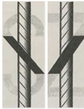
Şekil 1.1: Bir iplik bükümü (S-büküm ve Z-büküm).
