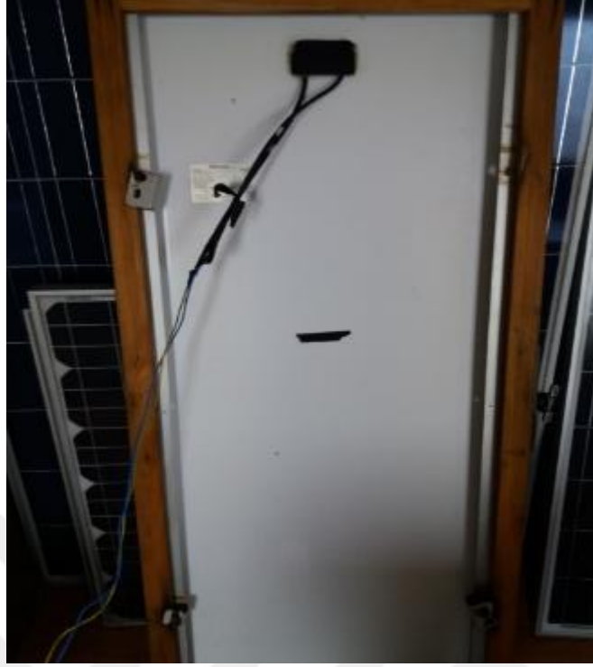
Resim 3.4 Panelin ahşap iç çerçeveye montajı.
