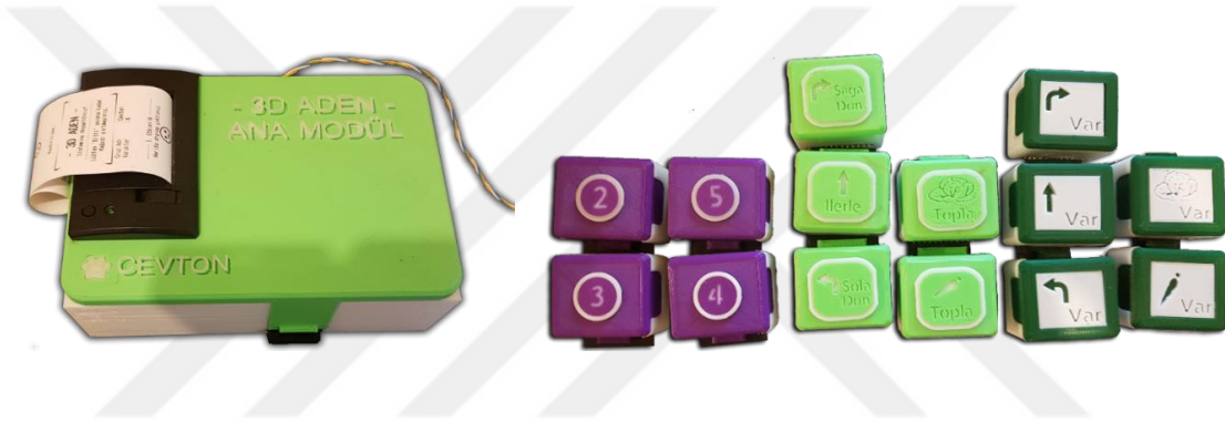
Görsel 2.2. Sol tarafta 3D ADEN Donanımının ana modülüne, sağ tarafta ise sırasıyla sayı modülleri, temel modüller ve şart modüllerine ait görseller.
