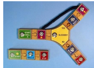
Görsel 1.6. Tern sisteminin modülleri (solda) ve Tern sistemiyle oluşturulmuş örnek bir algoritma (sağda) (Horn ve Jacob, 2007b).
