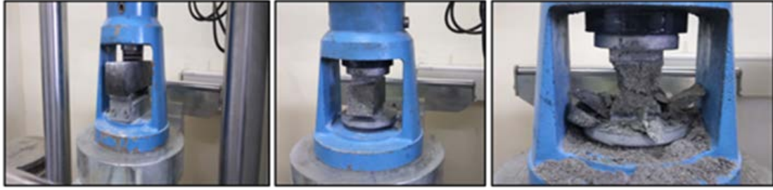
Şekil 19. Prizmatik numune örnekleri üzerinde yapılan eğilmede çekme ve basınç dayanımı deneyleri
