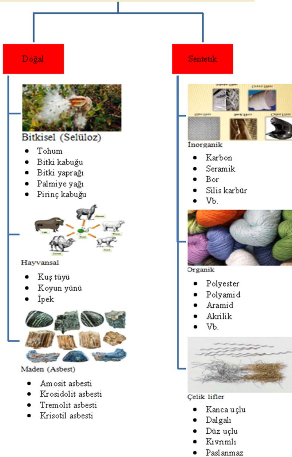
Şekil 6. Alkali aktivasyonlu betonların özelliklerini iyileştirmek için kullanılan liflerin sınıflandırılması (Amran vd., 2022).
