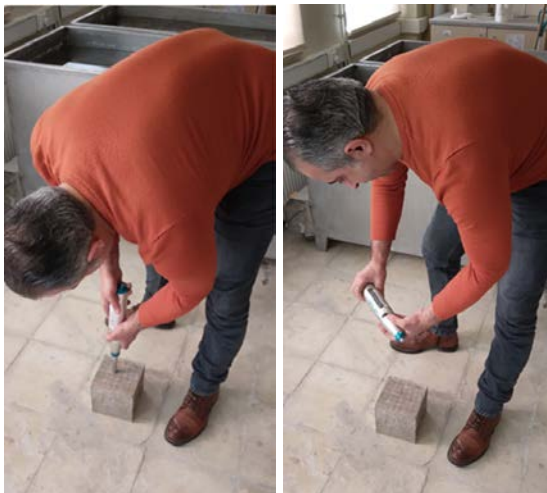
Şekil 23. Schmidt çekici deneyinin uygulanması
