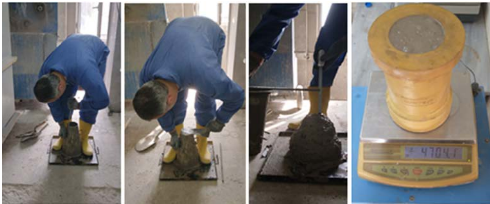
Şekil 20. Serbest çökme (Slump) deney düzeneği-ölçümü ve taze beton birim kütlesinin belirlenmesi
