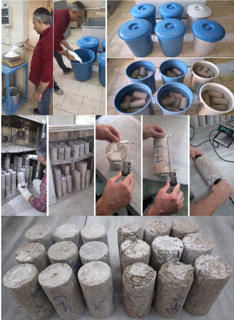
Şekil 35. Numunelerin %5 ve %10 \text{Na}_2\text{SO}_4 çözeltisine maruz bırakılması ve her 5 çevrim sonunda verilerin alınması
