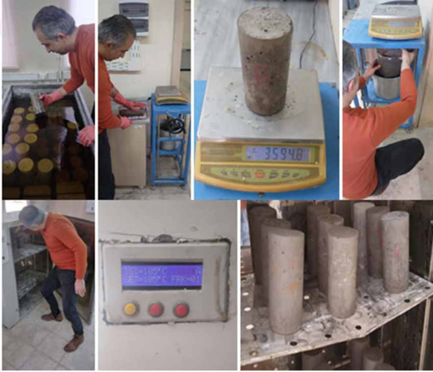
Şekil 21. Beton numunelerinin fiziksel özelliklerinin belirlenmesi
