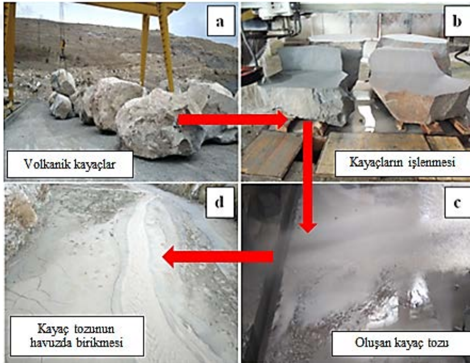
Şekil 10. (a) Volkanik kayalar, (b) Kayaçların işlenmesi, (c) Oluşan kayaç atığı, (d) KT'nin çökeltme havuzunda birikmesi
