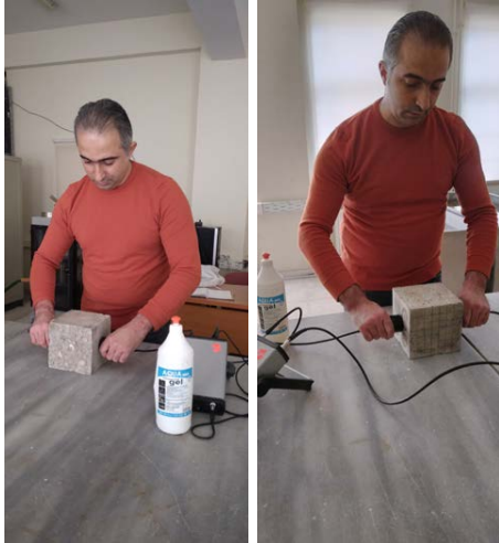
Şekil 22. Numuneler üzerinde ultrases deneyinin yapılması
