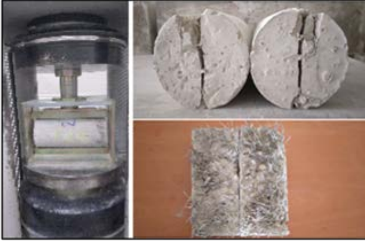
Şekil 30. Yarmada çekme dayanımı deneyinin yapılışı
