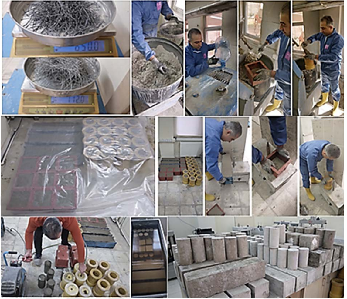
Şekil 17. AAB'nin üretimi, numune kalıplarına dökümü ve kütü
