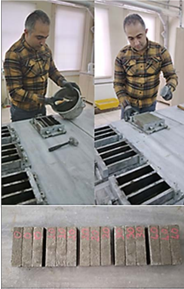
Şekil 18. Pozzolanik aktivitenin belirlenmesinde kullanılan numunelerin üretimi
