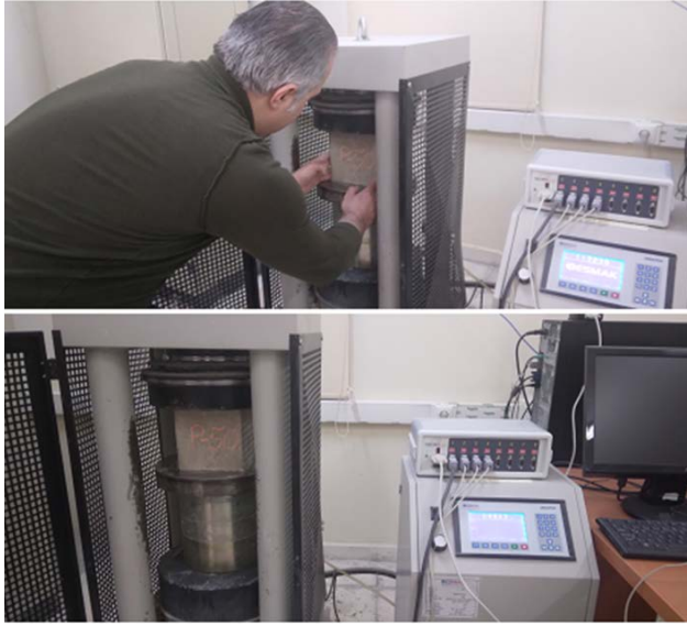
Şekil 25. Tek eksenli tahribatlı yöntemle beton basınç dayanımının belirlenmesi
