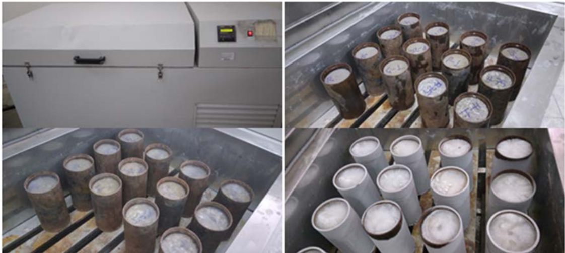
Şekil 33. Donma-çözülme döngüsüne maruz kalan alkali aktivasyonlu beton örnekleri
