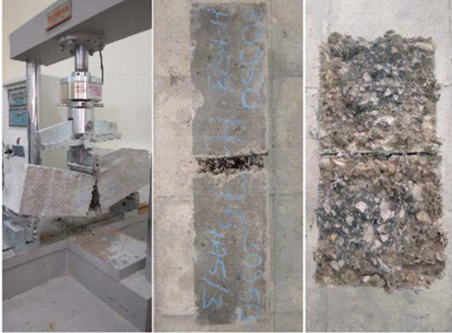
Şekil 31. Eğilmede çekme dayanımı deneyinin yapılışı
