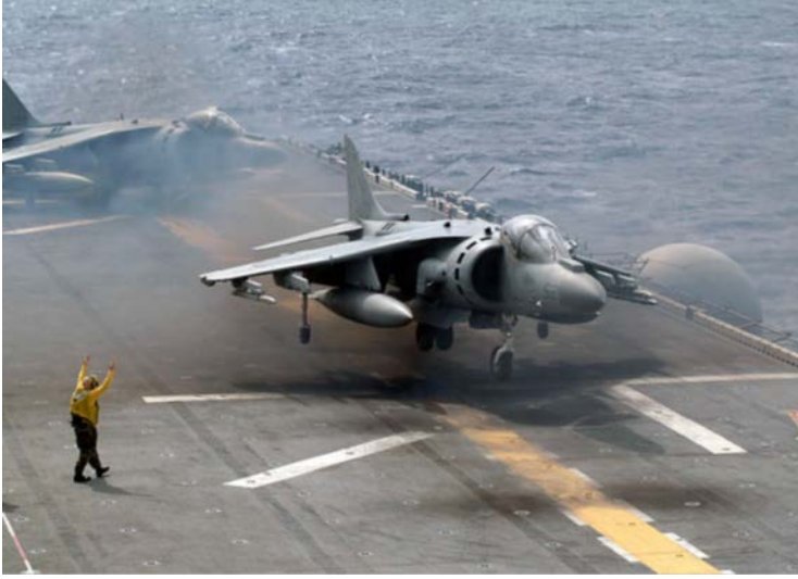
Şekil 5. AV8B-Harrier uçakları, operasyonel dikey iniş ve kalkış sırasında yüzeyde yüksek sıcaklıklar üretmektedir (Vickers vd., 2015; Kuranlı, 2020).
