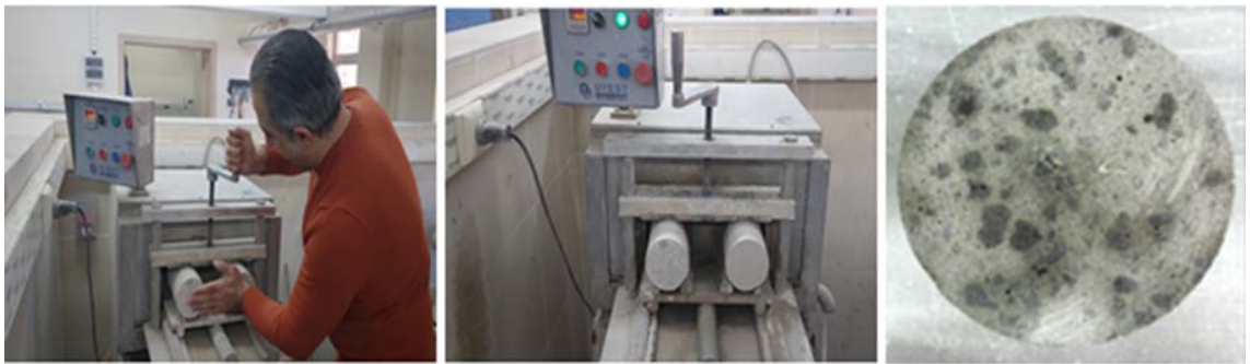
Şekil 27. Numune başlıklama cihazı ve yüzeyi düzeltilmiş numune
