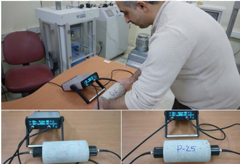
Şekil 34. Numunelerde oluşan içyapı hasarının tespitinin belirlenebilmesi için ultrasonik geçiş hızı deneyinin yapılışı
