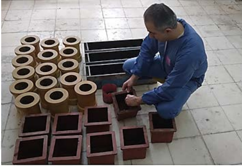
Şekil 15. Çalışmada kullanılan kalıplar ve kalıpların yağlanması
