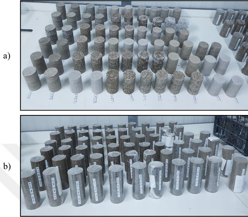
Şekil 4.6. SBD testi için hazırlanan numuneler a) Havada kurutulan numuneler b) Plastik filme sarılmış numuneler.
