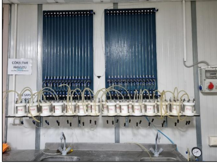
Şekil 3.9. Çalışmada kullanılan düşen seviyeli permeabilite test sistemi.
