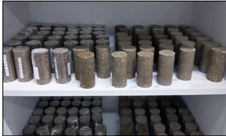
Şekil 4.7. SBD deneyi için dolapta bekletilen numuneler.
