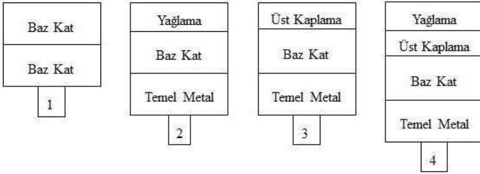
Şekil.4.2. Temel çinko lamelli kaplama sistemleri [14]
