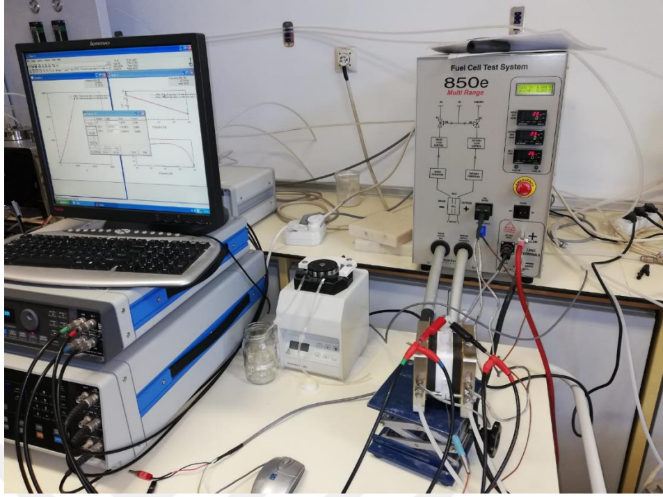
Görsel 10.8. Scribner 850e Fuel Cell Test istasyonu ve Bekktech İletkenlik Test Hücresi
