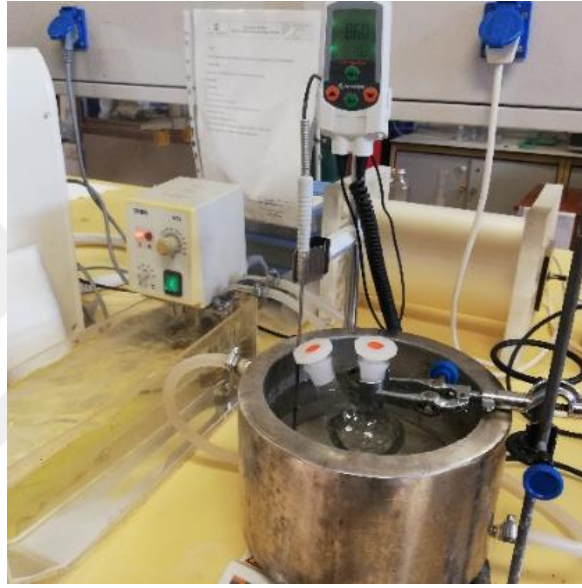
Görsel 10.1. Polimer çözeltileri hazırlama düzeneği
