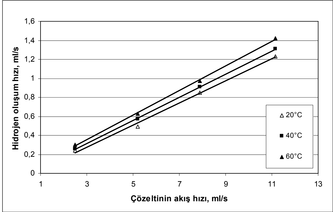
Şekil 4.35. % 5 NaOH konsantrasyonda Pt-%0,5 katalizörü için değişik sıcaklıklarda çözelti akış hızının hidrojen oluşum hızına etkisi
