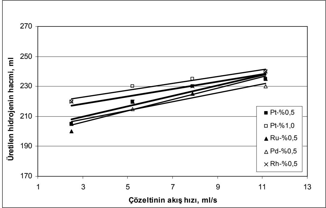
Şekil 4.27. % 5 NaOH konsantrasyonunda ve farklı katalizörler için çözelti akış hızının üretilen hidrojen hacmi ile değişimi (T=40°C)
