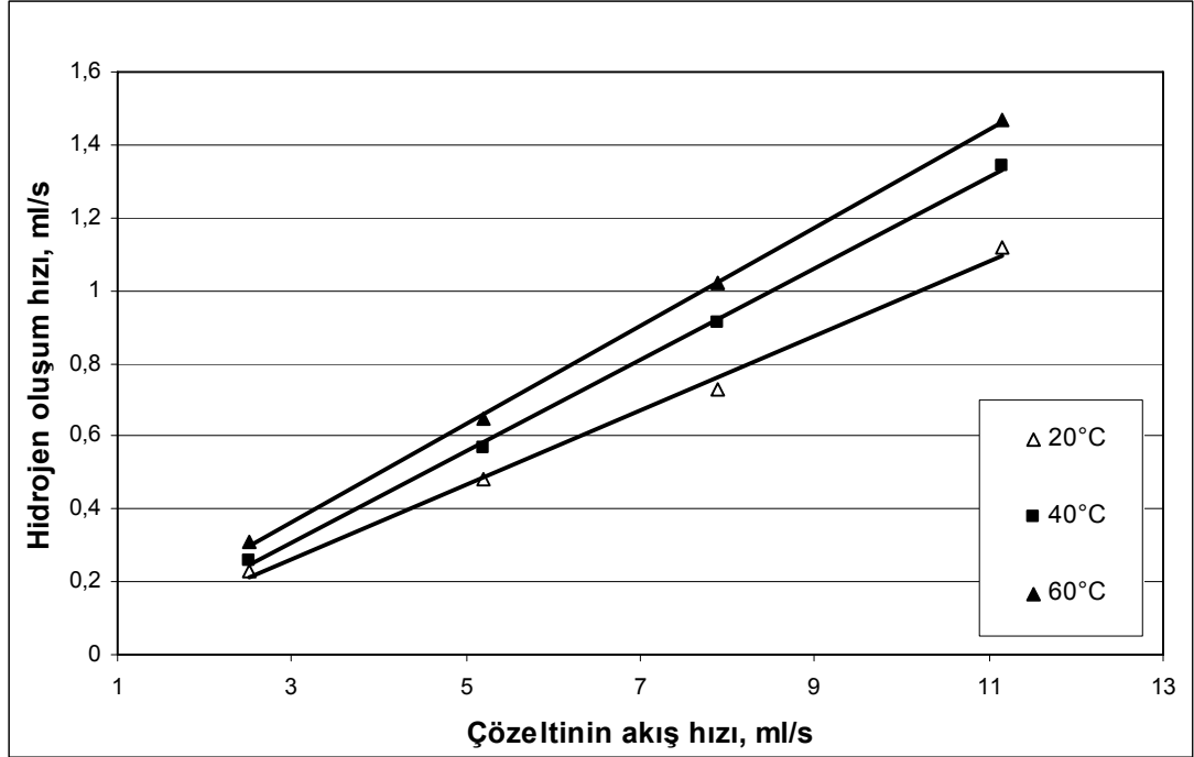
Şekil 4.43. % 1 NaOH konsantrasyonda Pd-%0,5 katalizörü için değişik sıcaklıklarda çözelti akış hızının hidrojen oluşum hızına etkisi
