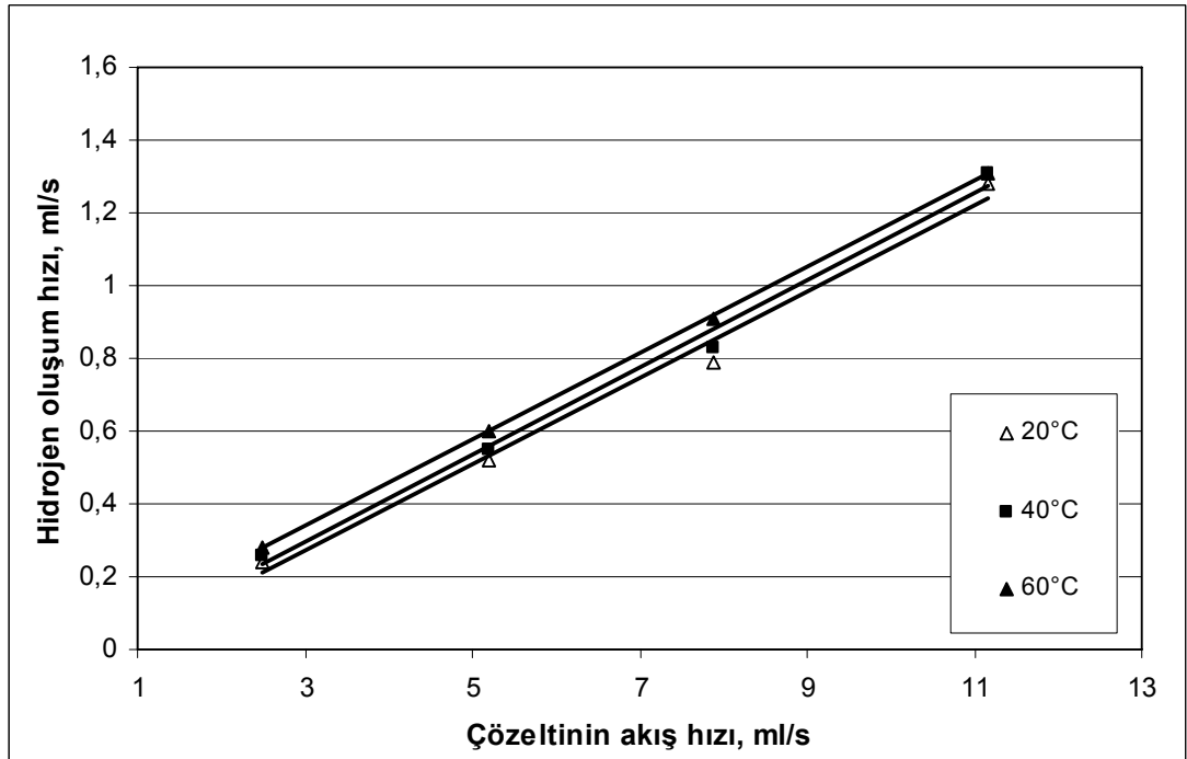
Şekil 4.42. % 10 NaOH konsantrasyonda Ru-%0,5 katalizörü için değişik sıcaklıklarda çözelti akış hızının hidrojen oluşum hızına etkisi
