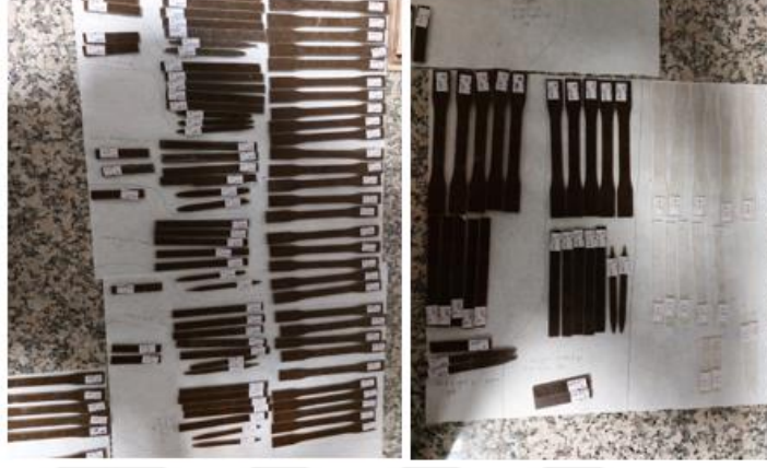
Şekil 6.10: Su jeti işlemi sonrasında şartlandırılmış odada bekletilen numuneler.
