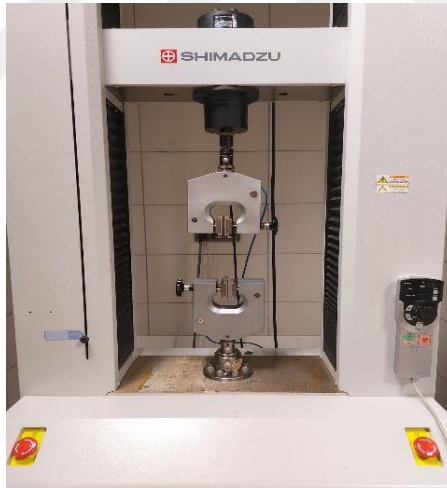
Şekil 6.12: Çekme testi için kullanılan cihaz.
