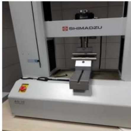
Şekil 6.11: Eğilme testi için kullanılan cihaz.
