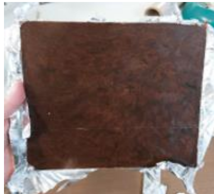
Şekil 6.9: Presleme işlemi sonrasında elde edilen biyokompozit.
