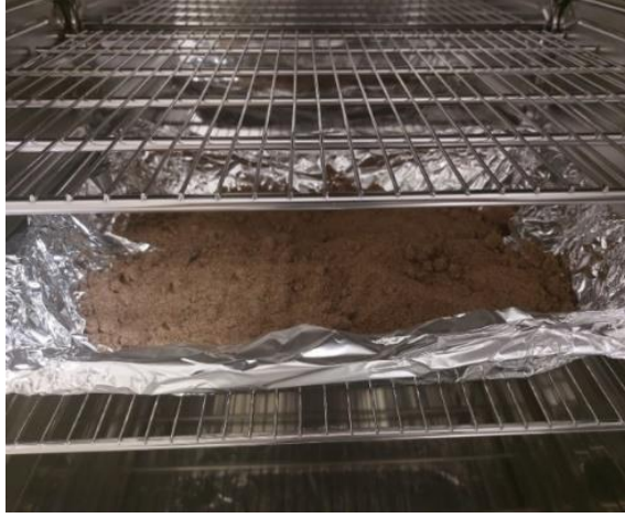
Şekil 6.5: Modifikasyona uğrayan örneklerin etüvde kurutulma işlemi.
