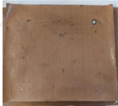
Şekil 6.8: İki tarafıda yanmaz kağıt ile kaplı prese hazır kalıp görüntüsü.
