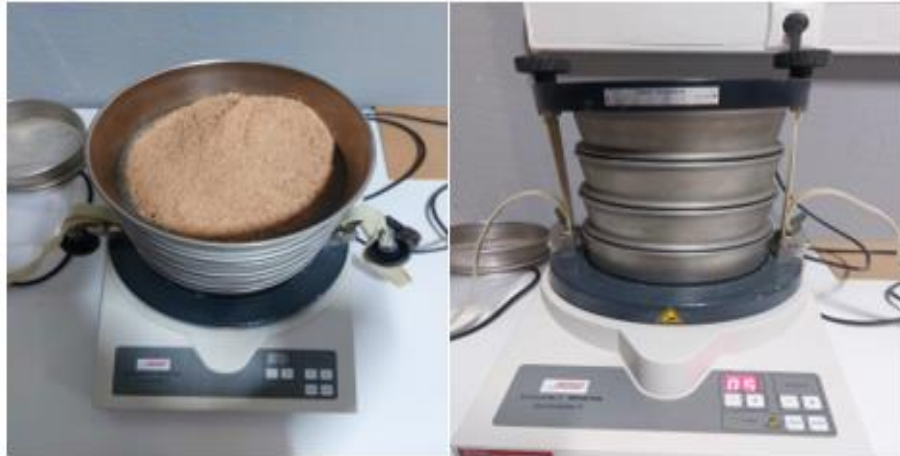
Şekil 6.2: Eleme aşamasında kullanılan cihazlar.
