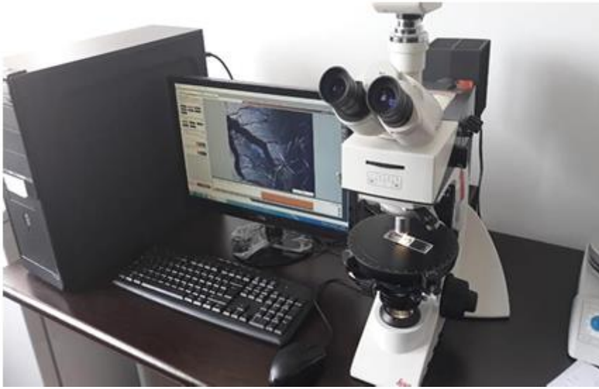
Şekil 3. 3. Leica marka polarize optik mikroskop ve görüntüsü
