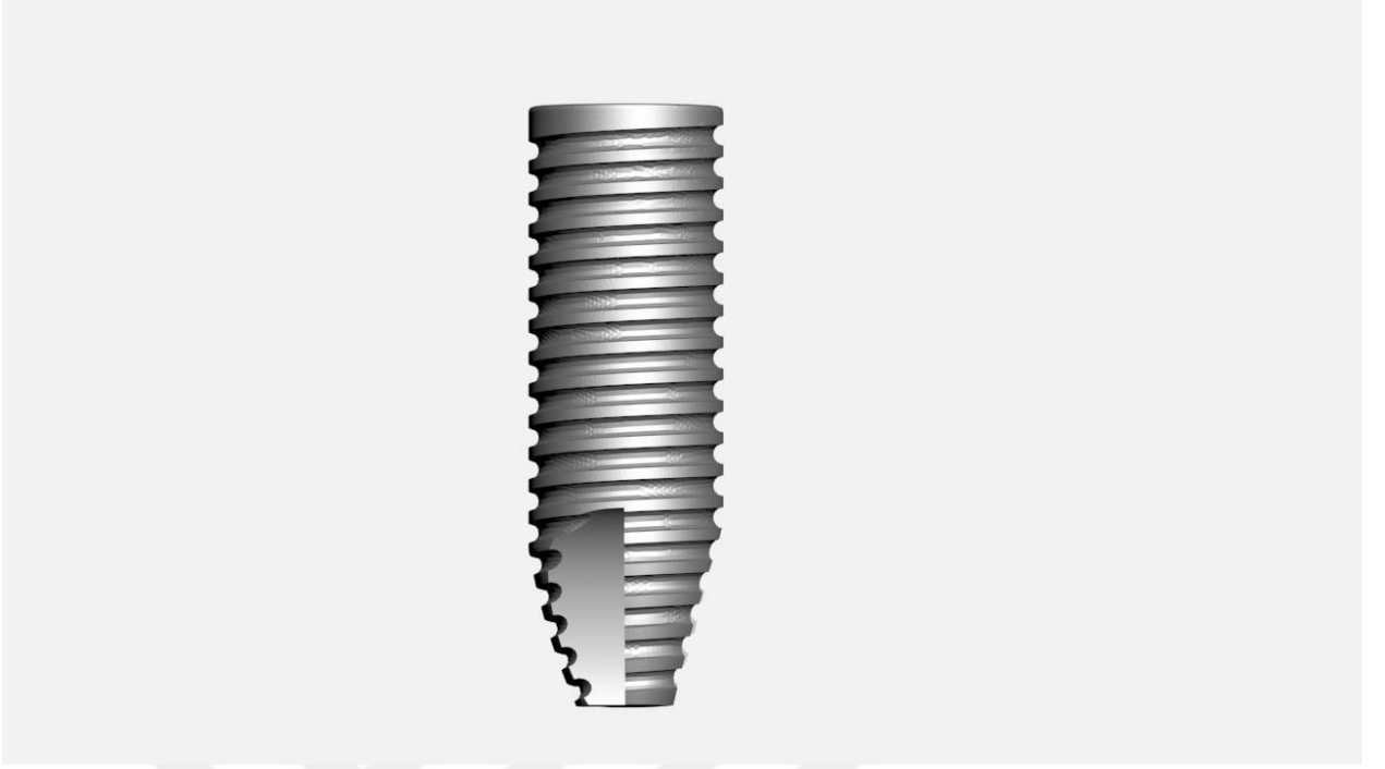
Şekil 3-1: Model 1&2 Anterior İmplant (3,75 mm \varnothing 11 mm boy uzunluğuna sahip implant modeli)
