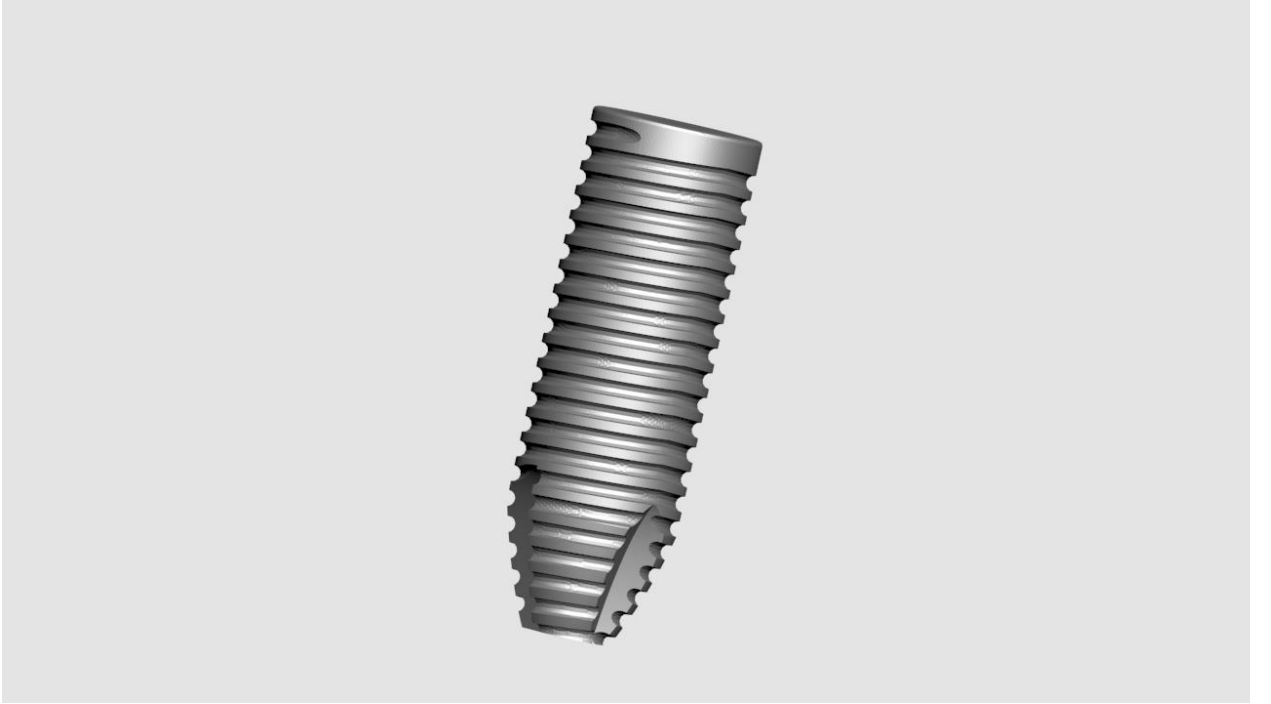
Şekil 3-2: Model 1&2 Posterior İmplant (4,3 mm \varnothing 13 mm boy uzunluğuna sahip implant modeli)
